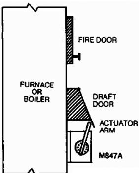
**Fig. 4. Actuator arm arrangement.**
