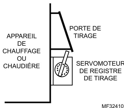
**Fig. 7. Emplacement type du servomoteur de registre de tirage avec bras de levier.**
