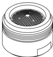
L'aérateur fourni avec le chauffe-eau devrait être installé afin d'assurer la température de sortie et la performance globale optimale de votre chauffe-eau sans réservoir.
