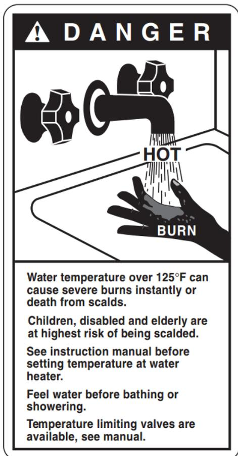
**Avis :** Des mitigeurs sont recommandés pour réduire la température au point d'utilisation en mélangeant l'eau chaude et froide dans les embranchements des conduits d'eau. Il est recommandé que les mitigeurs installés soient conformes avec la norme ASSE 1017 pour les mitigeurs thermostatiques des systèmes de distribution de l'eau chaude.
