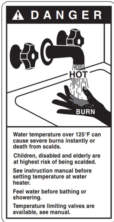
**Aviso:** Se recomiendan las válvulas mezcladoras para reducir la temperatura del agua en el punto de uso mezclando agua caliente y fría en las tuberías de derivación. Se recomienda instalar una válvula mezcladora que cumpla con la Norma para Válvulas Mezcladoras Activadas por Temperatura para Sistemas de Distribución de Agua Caliente ASSE 1017.
