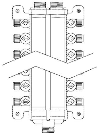
**FIGURE 5— ManaBloc® PARALLEL WATER DISTRIBUTION SYSTEM**
