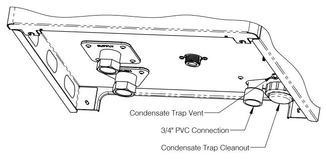
Figure 13-1: Condensate Trap
