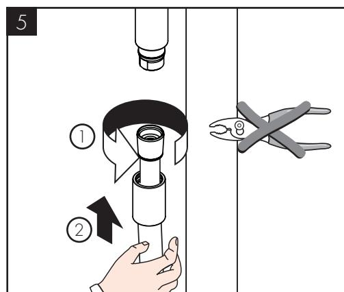
REVERSE THE FUNCTION BLOCK / MONTEZ LE BLOC DE FONCTION À 180° /
