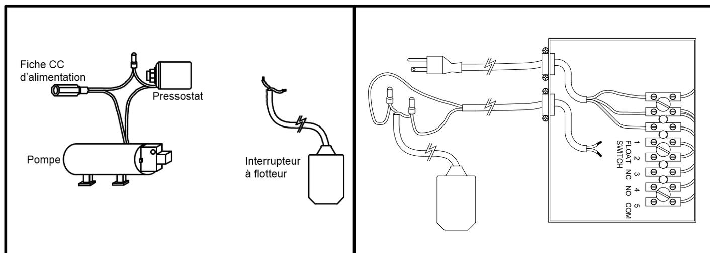
3. Branchez les fils pour refaire un circuit du MF200 sans l'interrupteur à flotteur.
