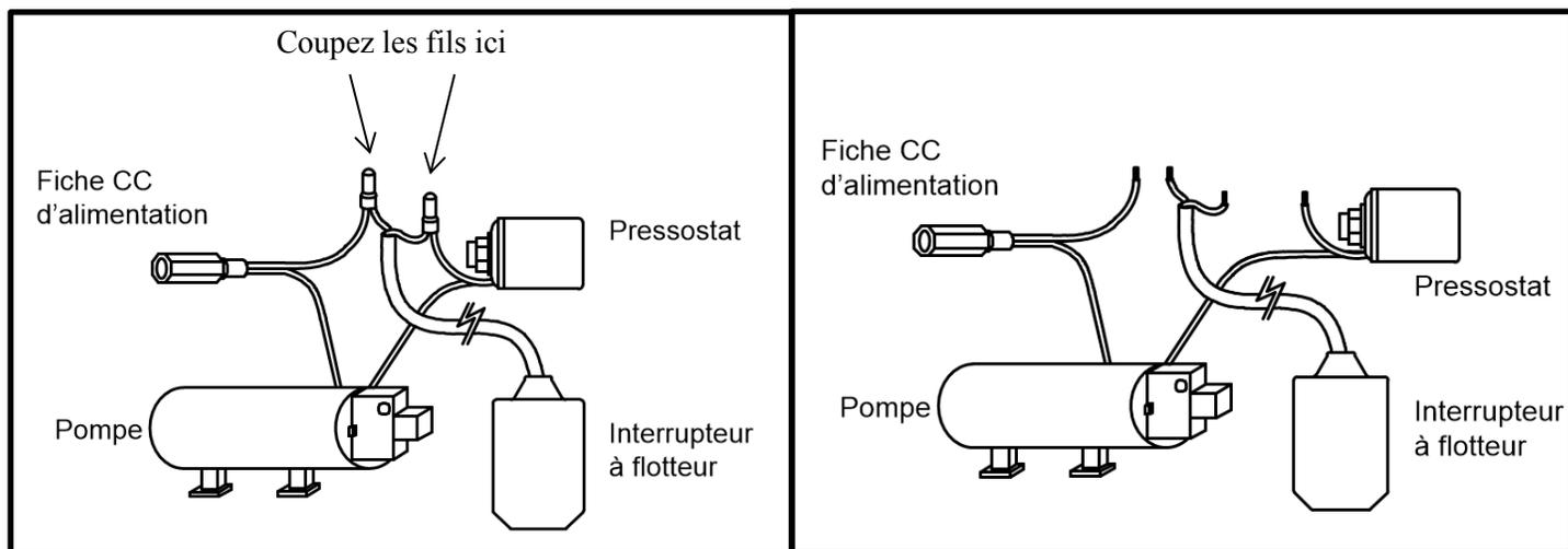
1. Coupez les fils qui relient l'interrupteur à flotteur au circuit du MF200.
