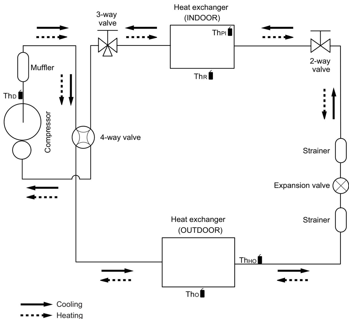
$Th_D$  : Thermistor (Discharge temperature)
