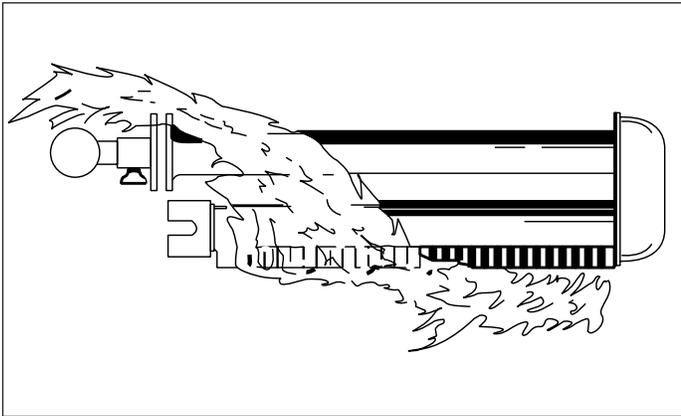
Figure 28.4 - Flamme rouillante
