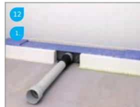
Verbreiding van Ø40mm naar Ø50mm na maximaal 1m of vóór een bocht / Increase the waste pipe from Ø40mm to Ø50mm after 1m (max.) or before a bend / Augmenter le diamètre de l'écoulement en passant de 40 à 50mm après 1m (max.) ou avant l'utilisation d'un coude / Erweiterung von DN 40 auf DN 50 spätestens vor dem ersten Winkel, oder bevor 1 m Ablaufrohrlänge erreicht ist.
