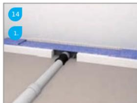
Specievloer aanbrengen afhellend (1 - 2%) naar de drain toe / Apply the screed with a fall (1 - 2%) towards the drain / Faire la chape avec une pente (1 - 2%) en direction du drain / Der Estrich sollte auf der 2 cm breiten Vorderkante des Blocks abgezogen werden.
