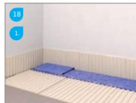
Tegellijm (EN12004C2) uitstreken: 20cm rondom de drain / Spread of the tile adhesive (EN 12004 C2): 20cm around the drain / Appliquer de la colle à carrelage (EN 12004 C2): 20 cm autour du drain / Um die Rinne im Bereich des Dichtungsvlies, 20cm Flexkleber EN 12004 C2 aufziehen
