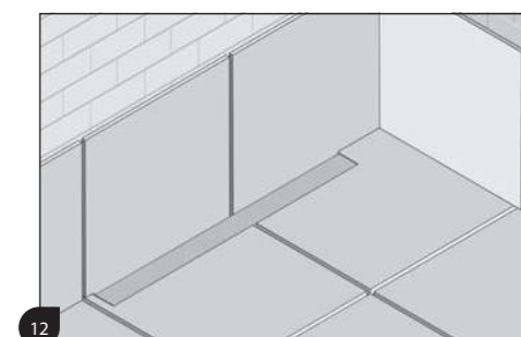
12 Wandtegels plaatsen / Fixation of the wall tiles / Pose du carrelage mural / Wandfliesen mit Flexkleber anbringen.
