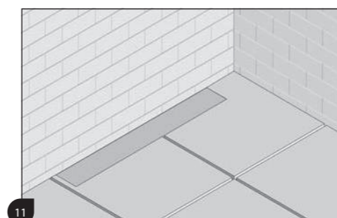
11 De laatste rij vloertegels aanbrengen en inkloppen met een rubberen hamer / Lay the last row of floor tiles and tap them into the mortar by using a rubber mallet / Positionner la dernière range de carreaux de sol et tapotez-les avec le maillet de caoutchouc / Die letzte Zeile Bodenfliesen verlegen und mit Hilfe von einem Gummihammer in den Mortel festklopfen.
