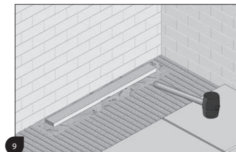
9 De tegels aanbrengen en inkloppen met een rubberen hamer in de richting van de drain / Lay the tiles towards the drain and tap them into the mortar by using a rubber mallet / Poser les carreaux du sol et tapotez-les avec le maillet de caoutchouc dans la direction du drain / Die Bodenfliesen in Richtung Rinne verlegen und mit Hilfe von einem Gummihammer in den Mortel festklopfen.
