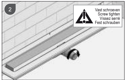
Het buitenschroefdeel op het binnenschroefdeel schroeven / Screw the outer screw part on the inner screw part / Visser la sortie sur le filetage prévu a cet effet / Den aussenliegenden Schraubstützen fest auf den innenliegenden aufdrehen
