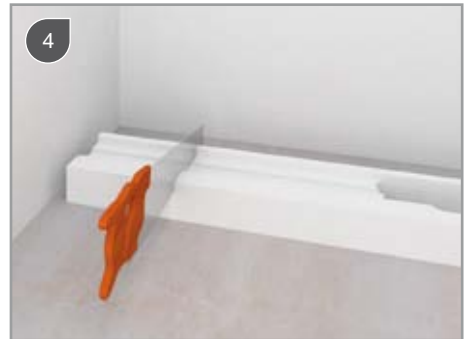
Installatieblok op maat versnijden indien nodig / If necessary cut the polystyrene installation block on the requested dimension / Coupez le bloc d'installation sur la mesure demandée si neces- saire / Schneiden Sie den Polystyrolblock auf das benötigte Rinnenmaß zu.
