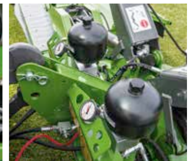
En unik patent utgjør den store forskjellen. TurboLift hydropneumatisk vektavlastning tillater trinnløs justering av bjelkestrykket under kjøring.
