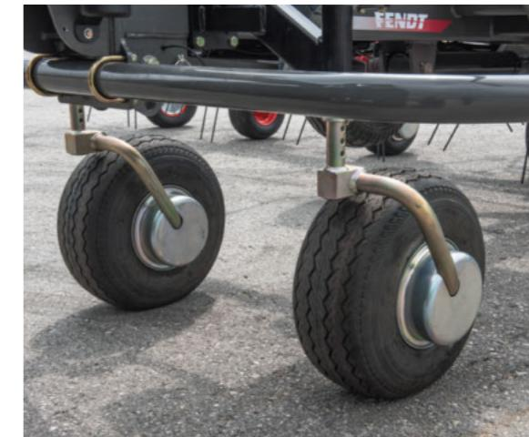
□ De bevegelige støttehjulene sørger for enda renere fôr og skånsom raking under vanskelige forhold og kan leveres som tilleggsutstyr. (Fendt Twister 901 T)
