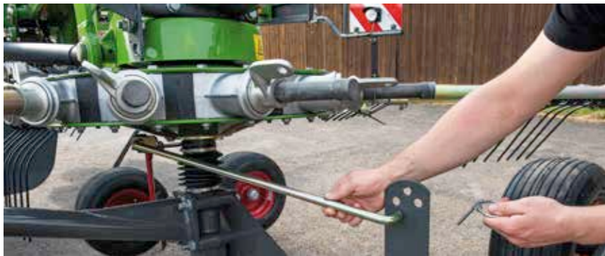
Kambanejustering uten verktøy: Ganske enkelt ved å sette staget i ønsket hull.
