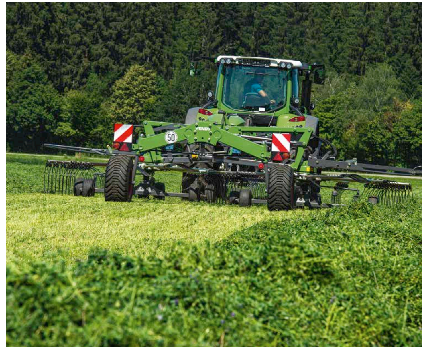
Praktisk, ergonomisk, godt gjennomtenkt: Modellene med én rotor samt sidelevering med flere rotorer (Multi-rotor) legger ranken ut til høyre side.
