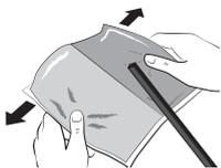
2. Das Harz und der Härter werden vermischt, indem man den Clip entfernt und den Beutelinhalt mischt. Zur Entfernung des Clips nehmen Sie die beiden Endkappen ab, greifen den Beutel an beiden Enden und ziehen diese behutsam auseinander.
