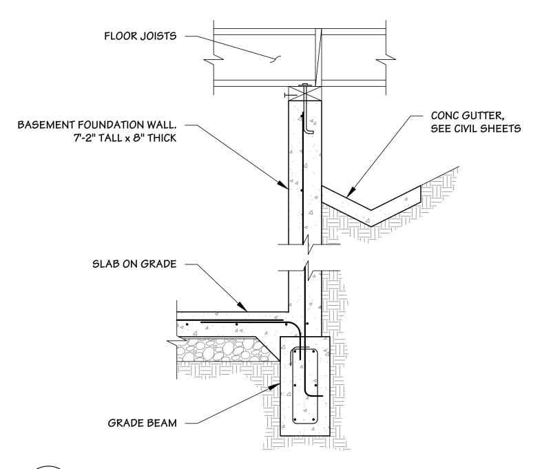
FOUNDATION RETAINING WALL AND TORSION GRADE BEAM
