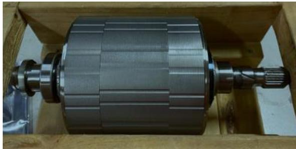
Figure 1 : rotor de la Tesla Model 3 (exemple de moteur à encoche vrillée par étapes)
