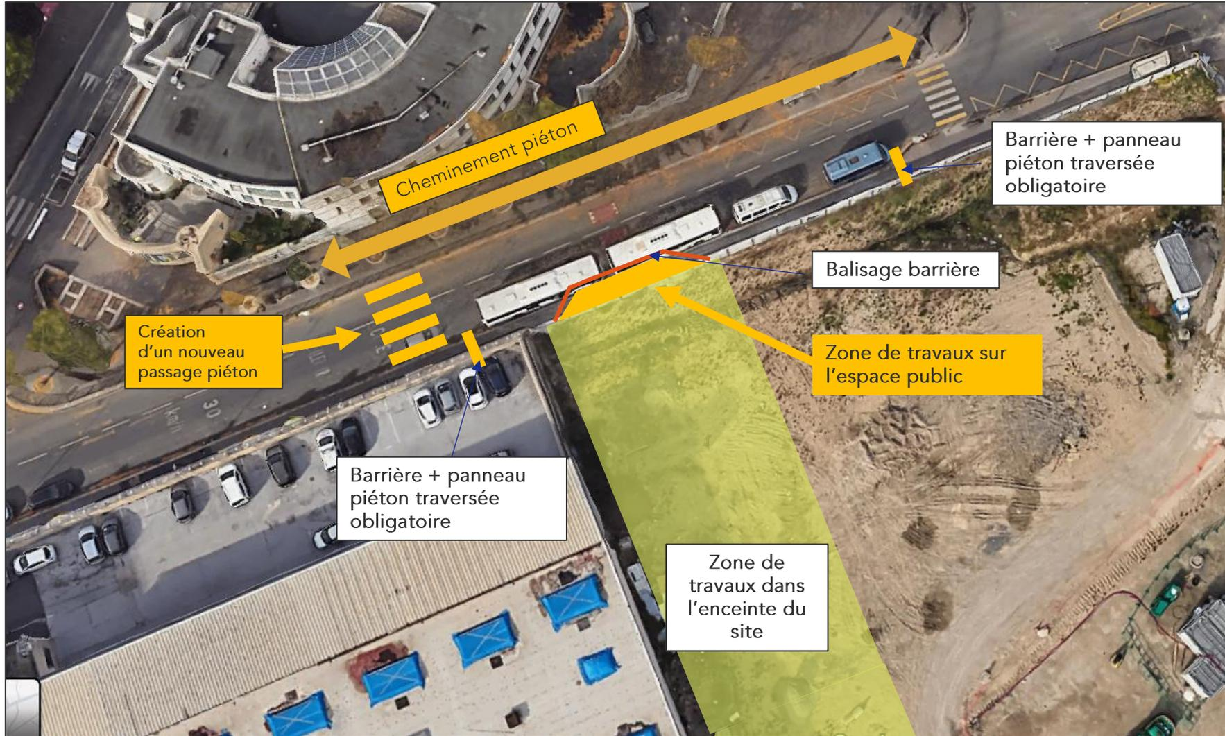
Afin de réaliser la nouvelle sortie, il est nécessaire d'abaisser une partie du trottoir de la rue.
