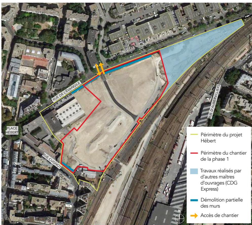
Préalable indispensable à la construction des immeubles, les travaux de viabilisation ont pour objectifs de raccorder le site aux différents réseaux qui permettront d'alimenter le futur quartier mais aussi de réaliser les premières voies qui le desserviront. Dans le cadre de ces travaux, les murs situés rue Cugnot et rue de l'Évangile seront partiellement démolis afin de créer les accès de chantier et de permettre le bon déroulement de celui-ci.
