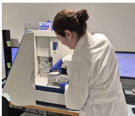
Probenverarbeitung für eine genetische Testung im Sequenziergerät
