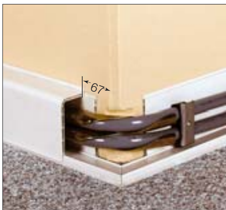
22. Ved udvendigt hjørne afskæres front-panelet som vist ovenfor. Front-panelerne skæres rent og i ret vinkel.
