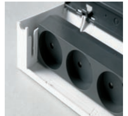
Anvendes lige stikpropper placerer du stikdåse-indsatsen i bageste rille, hvorved stikpropperne skjules under dækslet. Anvendes vinkelstikpropper placeres indsatsen i forreste rille.
