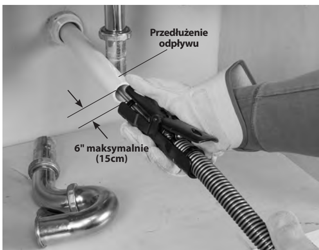
Rysunek 7 - Przykład przedłużania odpływu, aby osiągnąć odległość 6" (15 cm) dla jednostki AUTOFEED.
