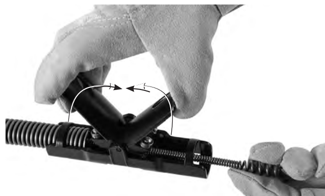
5. ábra – A kábel átvezetése az AUTOFEED® szerelvényen
