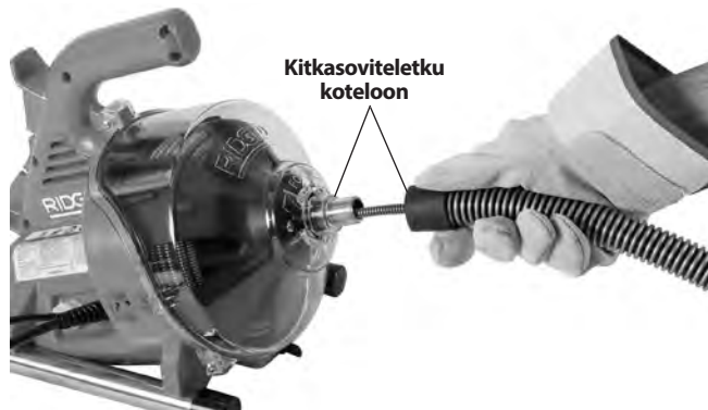
Kuva 4 – Jousen syöttäminen suojaletkun läpi
