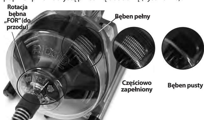
Rysunek 10 - Obserwowanie kabla w bębnie
