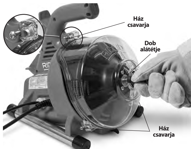
13. ábra – A lefolyótisztító gép felnyitása
