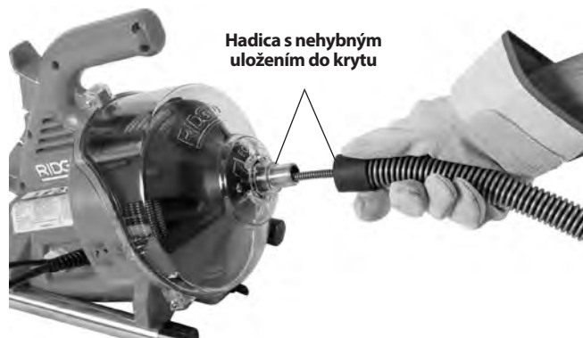
Obrázok 4 – Podávanie špirálového kábla do vodiacej hadice
