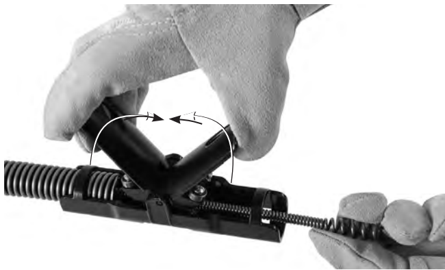
Şekil 5 - Kabloyu AUTOFEED® Montajı Boyunca Besleme
