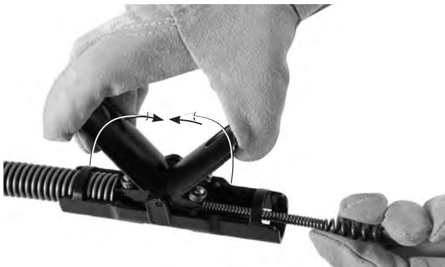
Slika 5 – Provođenje sajle kroz AUTOFEED® sklop
