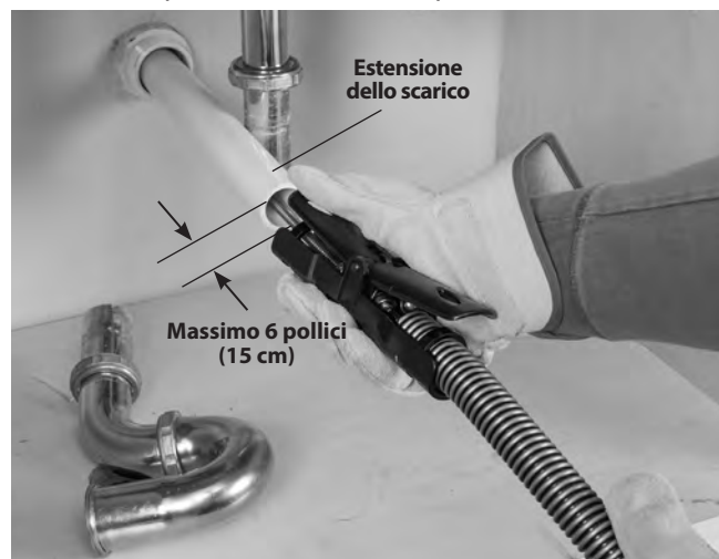
Figura 7 – Esempio di estensione dello scarico fino ad un massimo di 6 pollici (15 cm) dall'Unità AUTOFEED.
