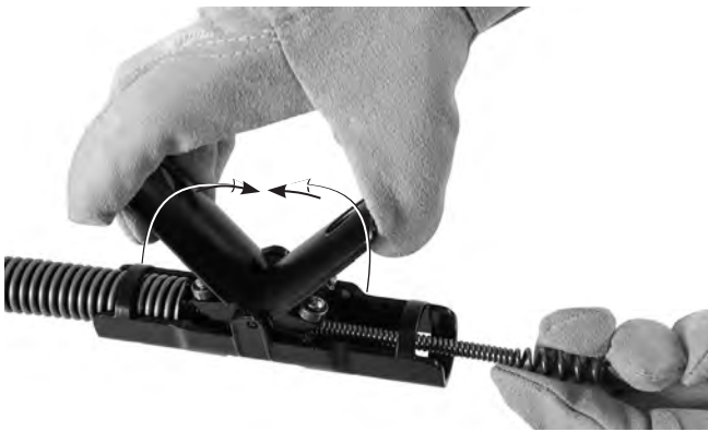
Abbildung 5 – Führen der Spirale durch die AUTOFEED®-Einheit
