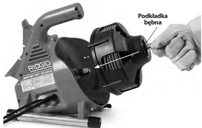
Rysunek 16 - Wkładanie bębna do maszyny
