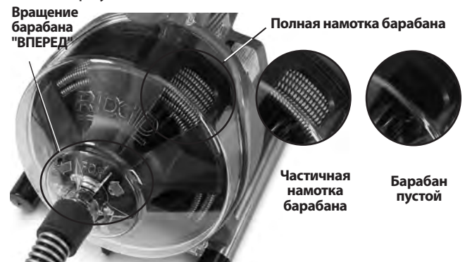
Рис. 10 – Контроль троса в барабане
