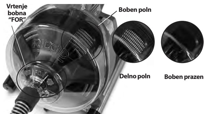
Slika 10 – Nadziranje kabla v bobnu
