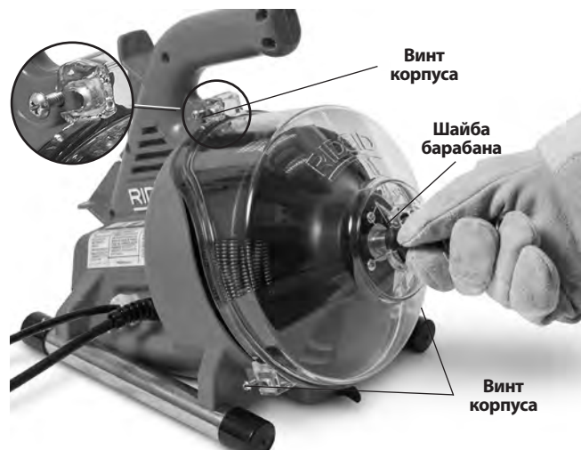
Рис. 13 – Открывание прочистной машины
