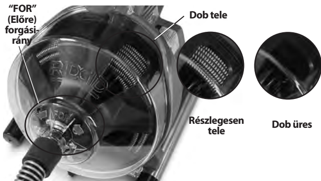
10. ábra – A dobban maradó kábel figyelése
