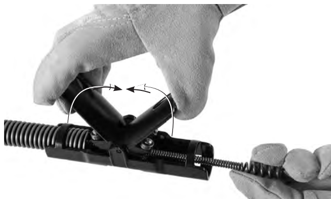
Figur 5 – Før kabelen gjennom AUTOFEED®-enheten
