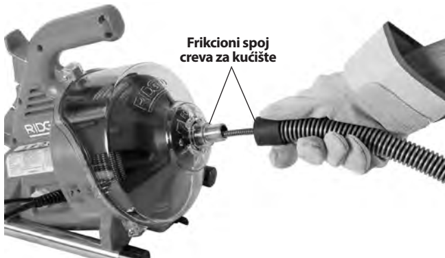
Slika 4 – Uvođenje sajle u crevo za navođenje
