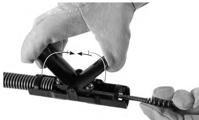
5-сурет – Кабельді AUTOFEED® жиынтығы арқылы өткізу
