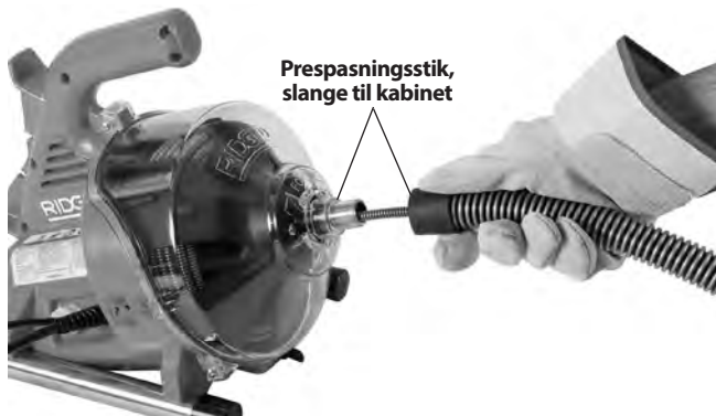
Figur 4 – Indføring af spiralen i styreslangen
