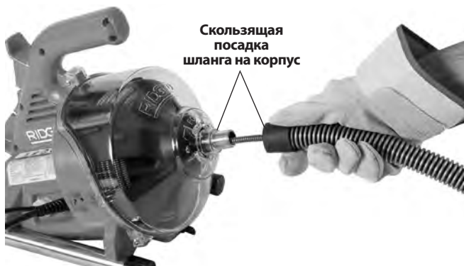
Рис. 4 – Поддача троса в направляющий шланг
