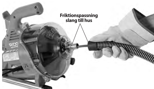
Figur 4 – Mata in spiralen i styrslangen
