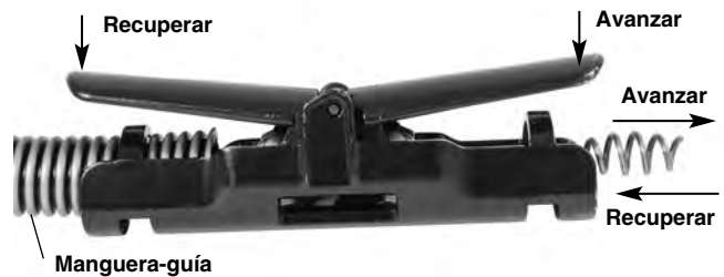
Figura 9 – Palancas para avanzar o recuperar el cable
