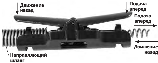
Рис. 9 – Рычаг подачи троса вперед/движения назад
