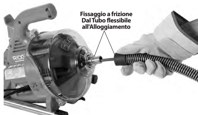
Figura 4 - Inserimento del Cavo nel Tubo guida
