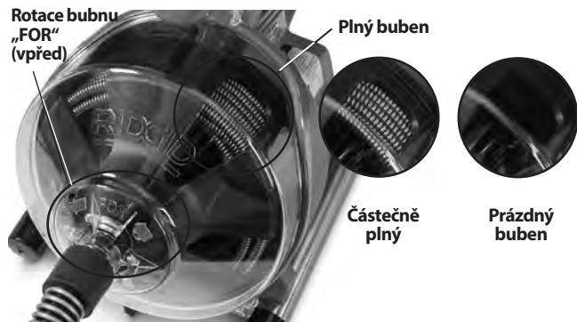
Obrázek 10 – Sledování kabelu v bubnu
