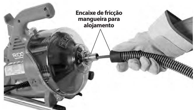
Figura 4 – Avançar o cabo para a mangueira guia
