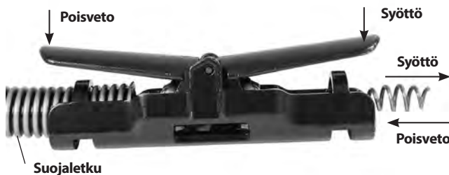
Kuva 9 – Eteen-/taaksesyöttövipu
