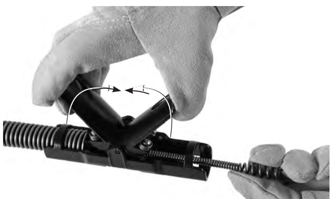
Рис. 5 – Поддача троса сквозь узел AUTOFEED®
