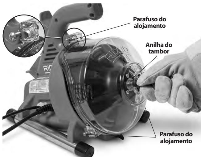
Figura 13 – Abrir a máquina de limpeza de tubagens
