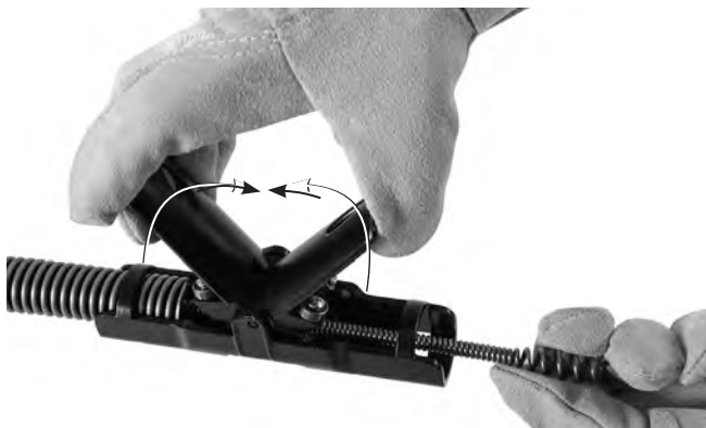
Kuva 5 – Jousen syöttäminen AUTOFEED®-kokoonpanon läpi
