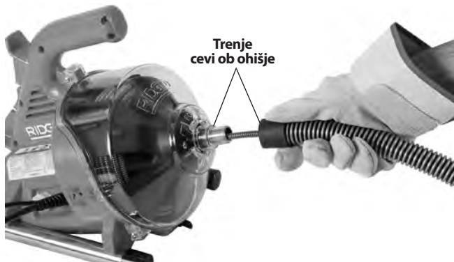
Slika 4 – Dovajanje kabla v vodilno cev
