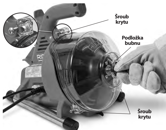
Obrázek 13 – Otevření čističe odpadů
