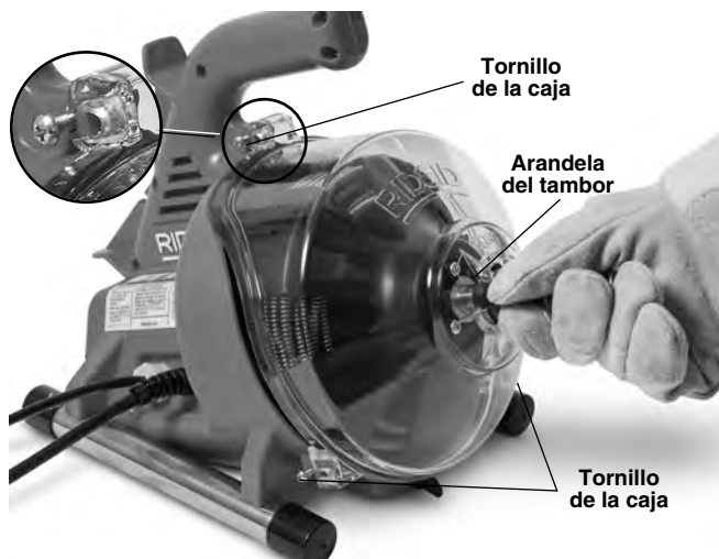
Figura 13 – Apertura de la limpiadora de desagües
