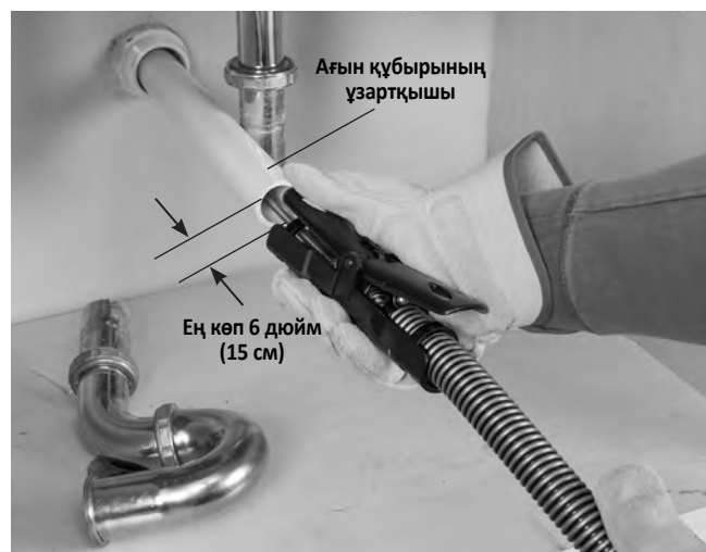
7-сурет – Ағын құбырын Autofeed бөлігінен 6 дюйм (15 см) шегінде созу үлгісі.
