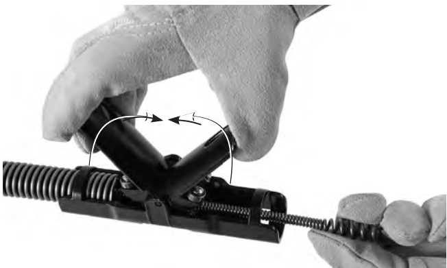
Figuur 5 – De kabel door de AUTOFEED®-eenheid voeren
