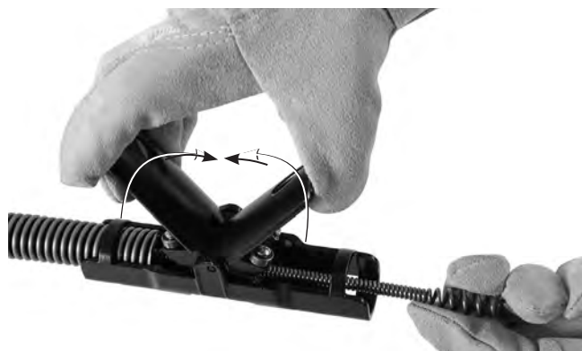
Rysunek 5 - Wprowadzanie kabla przez zespół AUTOFEED®
