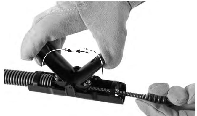
Slika 5 – Dovajanje kabla skozi sestav AUTOFEED®
