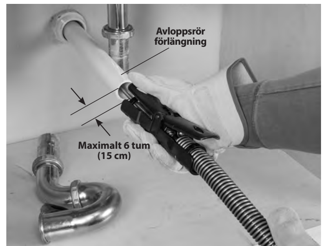
Figur 7 – Exempel på förlängning av avlopp till 6 tum (15 cm) från AUTOFEED-enheten.
