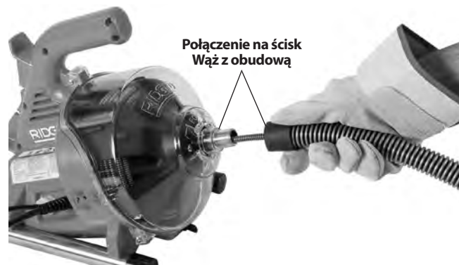
Rysunek 4 - Wprowadzanie kabla do węża prowadzącego
