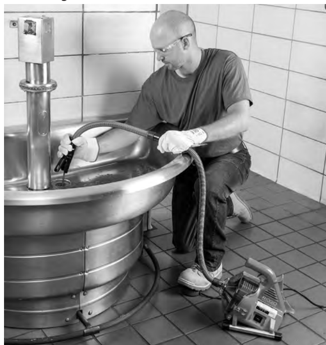
Abbildung 11 – Zurückziehen der Spirale
