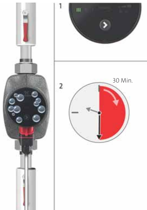
Fig. 8 Avluftning av pumpen
