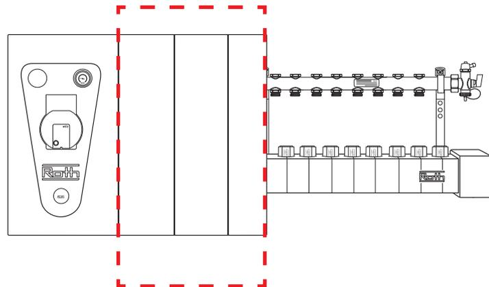
**(DK)** Isoleringen kan afkortes efter behov i skjærerillerne markeret i fronten og hele vejen rundt om isoleringen, enderne flyttes herefter ind for tilpasning. *OBS! Tilskæring gøres altid inden montage af GV Shunt.*
