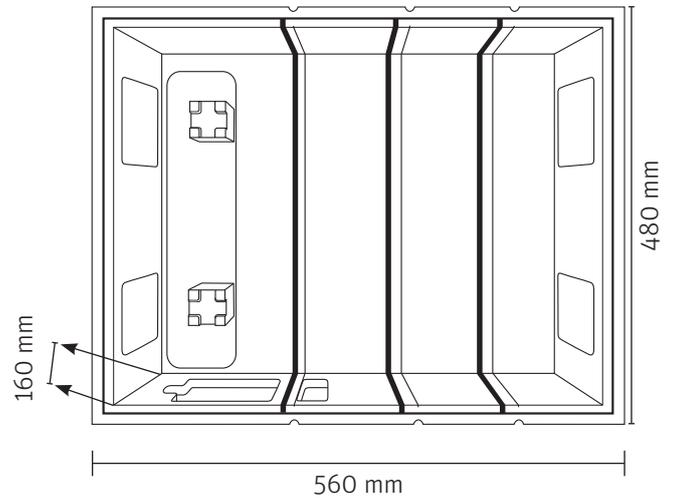
**(DK)** Shunten placeres på de formstøbte tårne, herefter kontrolmåles der fra top til midt rør som vist på tegning. Der skal være 85 mm. Ved montage af motorventil for vejrkompensering vendes ventilen som vist på tegning.
