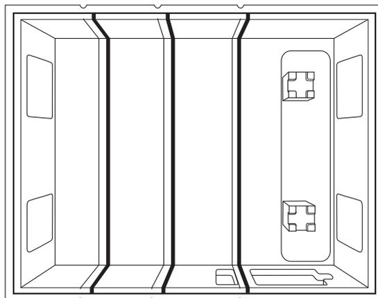
**(DK)** Shunten placeres på de formstøbte tårne, herefter kontrolmåles der fra top til midt rør som vist på tegning. Der skal være 85 mm. Ved montage af motorventil for vejrkompenisering vendes ventilen som vist på tegning.
