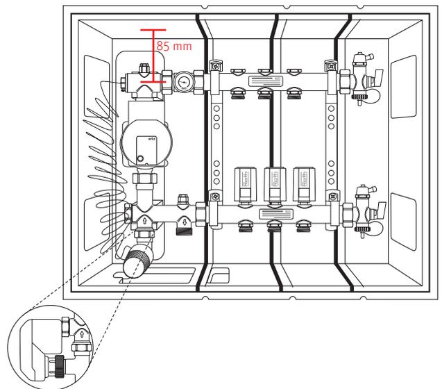
**(DK)** Afslut montering ved at trykke låget på. Isoleringen kan afkortes efter behov i skærerillerne markeret i fronten og hele vejen rundt om isoleringen. Enderne flyttes herefter ind for tilpasning.
