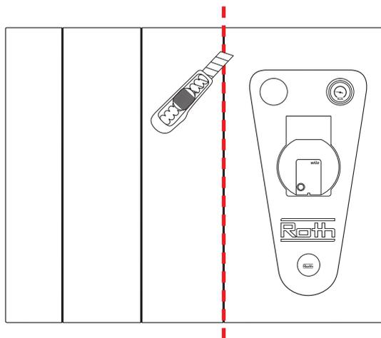
**(DK)** Isoleringen kan udvides med tilhørende isoleringskappe (VVS nr. 401973.890) som vist på tegning. Udskæringer for udvidelse fortages i endernes skjæreriller.
