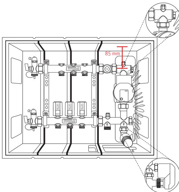
**(DK)** Afslut montering ved at dele låget i to som vist på tegning. Herefter monteres pumpedelen i højre side og resten af låget i venstre side. Den lille isoleringsprop for termometer flyttes fra venstre til højre hul. Anvendes der motorventil og ikke følerelement, lukkes fronten af med den medfølgende prop.
