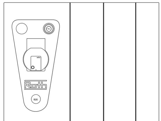
**(DK)** Isoleringen kan også spejlvendes hvis pumpen ønskes til højre. Vend isoleringen så de formstøbte tårne er i højre side, og afslut med at bytte om på top- og bundplade så hullerne igen er placeret i bunden.
