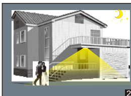
2 Quand la lumière ambiante est insuffisante, le capteur allume la lampe quand un mouvement est détecté.
