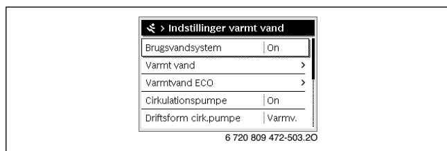
Fig. 14 Menuen Indstillinger varmt vand
