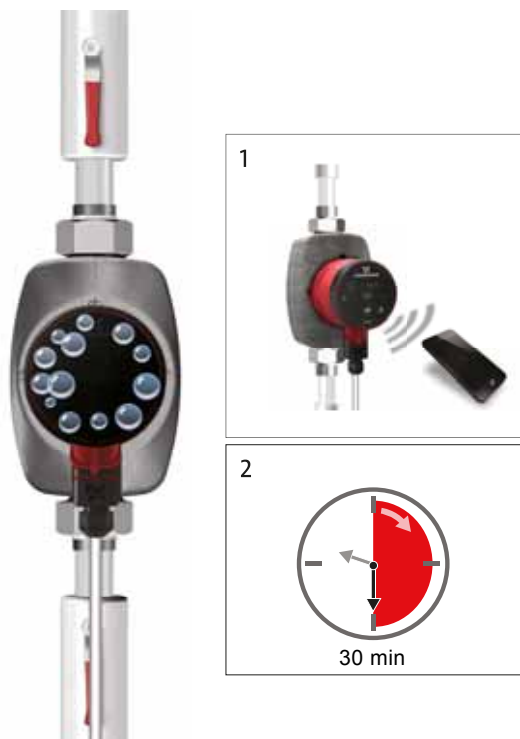
Fig. 7 Udluftning af pumpen
