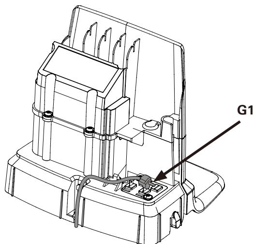
Schließen Sie den Führungsdräht wie folgt an die Ladestation an:
