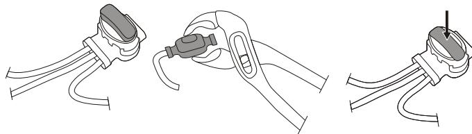
Вмъкнете двата края на ограничаващия проводник, както и края на направляващия проводник, в разклонението и конектора на направляващия проводник. Проверете дали проводниците са напълно вмъкнати в разклонението и конектора на направляващия проводник, така че краишата да се виждат през разклонението и конектора на направляващия проводник.
