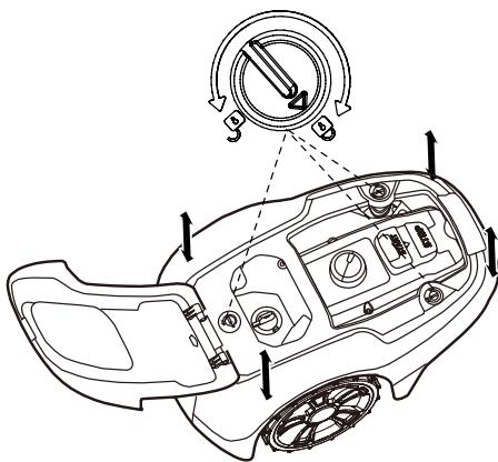
Drej håndtaget, så det er åbent, og løft med et fast tag et hjørne af kabinetten, og gentag for alle fire hjørner, indtil kabinetten løsner sig fra chassiset.
