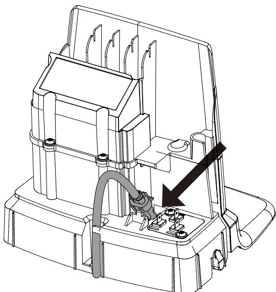
Csatlakoztassa a kisfeszültségű kábelt a töltőállomáshoz.
