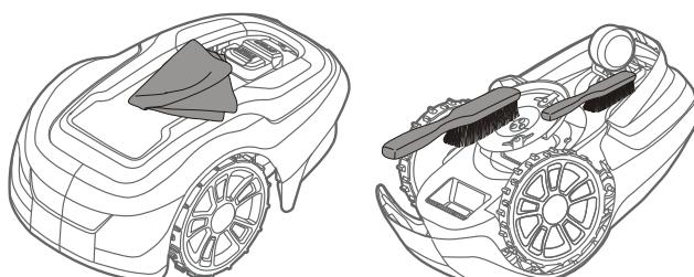
**VAROVÁNÍ!** Před čištěním stiskněte tlačítko STOP a vyjměte bezpečnostní klíč.
