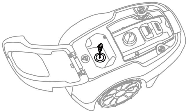
Inserte la llave en el cortacésped y gírela a la posición de encendido (I).
