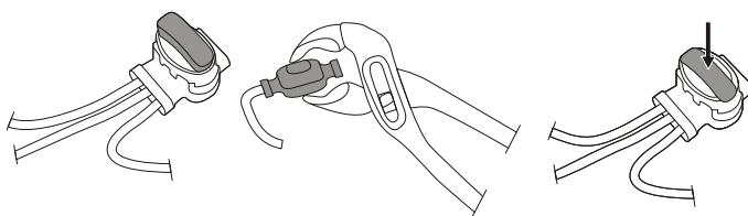
Włożyć oba końce przewodu granicznego oraz koniec przewodu prowadzącego do łączówki do sztukowania i prowadzenia przewodu. Sprawdzić, czy przewody są włożone do końca do łączówki do sztukowania i prowadzenia przewodu, tak że końce są widoczne przez łączówkę.
