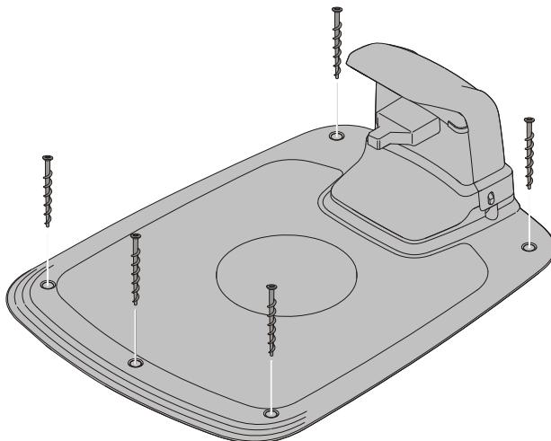
Proteja a estação de carregamento no chão usando os cinco parafusos de fixação fornecidos e uma chave Allen de 6 mm.
