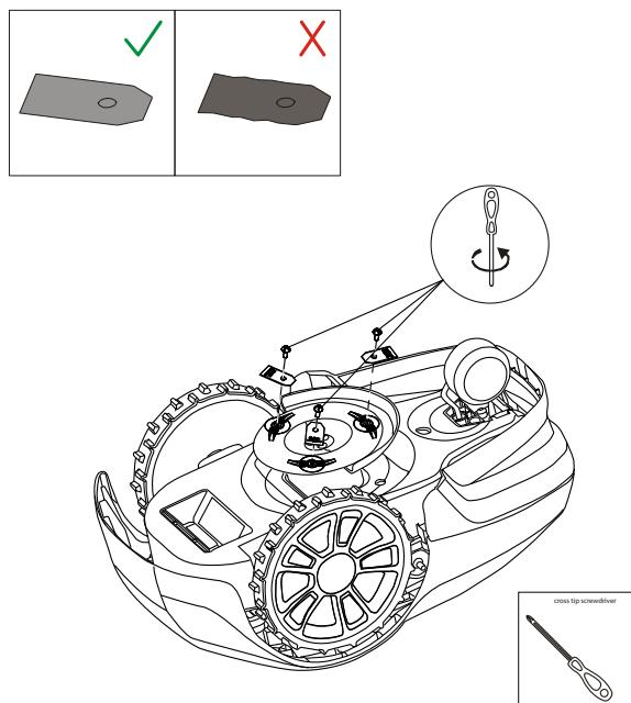
**AVVERTENZA!** Premere il tasto di ARRESTO e rimuovere la chiave di sicurezza prima di sostituire le lame; indossare guanti protettivi.
