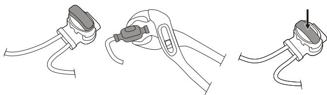
Ak je hraničný kábel príliš krátky, použite dodané spojky a konektory pre vodiaci kábel na pripojenie prídavného ohraničujúceho vodiča nasledovne:
