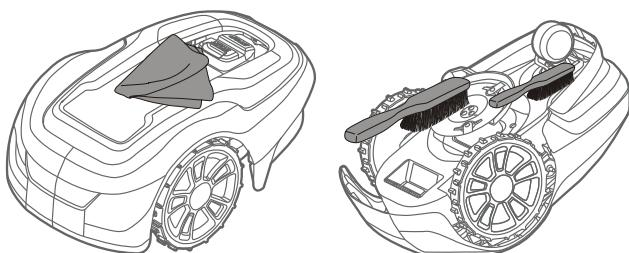
**OPOZORILO!** Pritisnite gumb STOP (USTAVI) in pred čiščenjem odstranite varnostni ključ.
