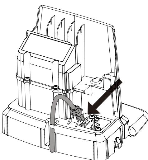
Schließen Sie das Niederspannungskabel an die Ladestation an.
