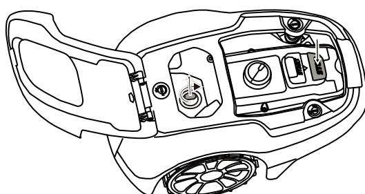
Apăsați butonul **STOP** de pe robot și îndepărtați cheia de siguranță.
