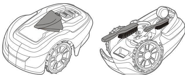
**WARNUNG! Drücken Sie die STOP-Taste und entfernen Sie den Sicherheitsschlüssel vor der Reinigung.**
