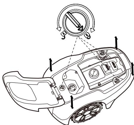
Поверните ручку в положение разблокировки и с усилием поднимите за один из углов корпуса, повторите операцию с четырех сторон — корпус отсоединится от шасси.
