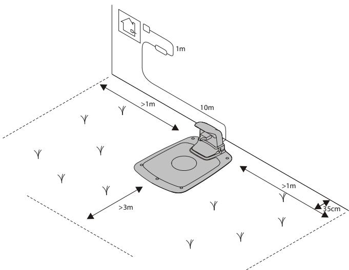
Pozitionarea stației de încărcare după cum urmează:
