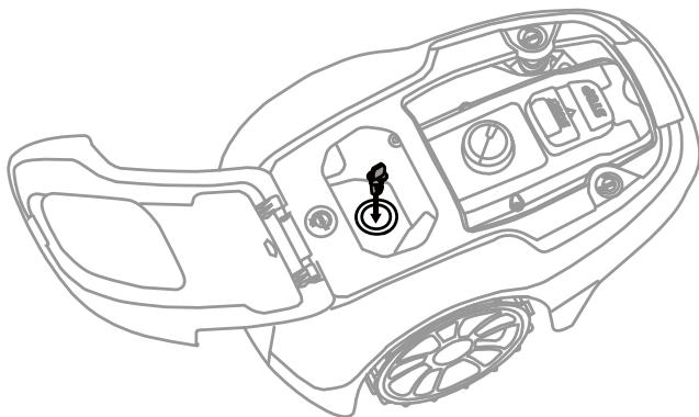
Introduceți cheia de siguranță în mașina de tuns și rotiți-o în poziția ON (I).
