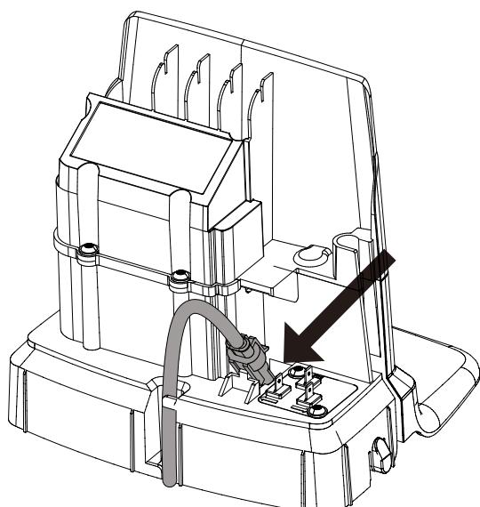
Sluit de laagspanningskabel aan op het laadstation.
