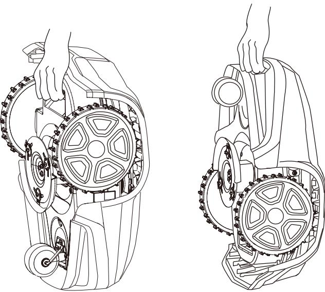
Pulse el botón de **PARADA** y retire la llave de seguridad antes de la elevación.
