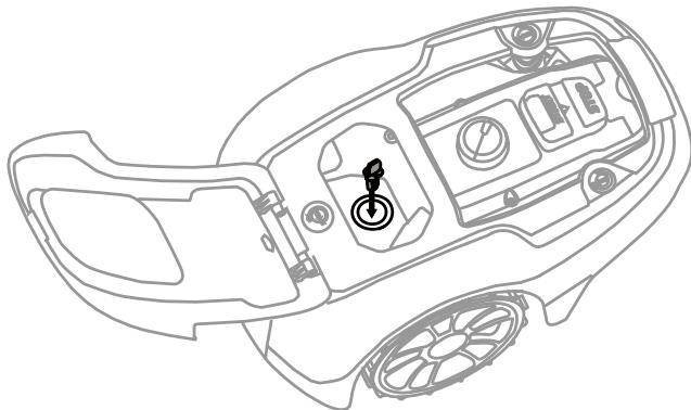
Ouvrez le capot de la tondeuse, insérez la clé de sécurité et tournez la jusque la position « **Marche** » ( || ).
