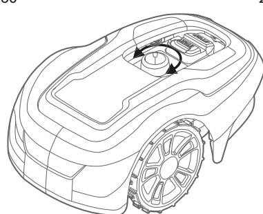
В течение нескольких первых недель эксплуатации высота скашивания травы должна составлять 60 мм, чтобы исключить контакта ножей с пограничным и направляющим проводами. Уменьшайте высоту скашивания травы каждую неделю, пока не будет достигнута желаемая высота скашивания.
