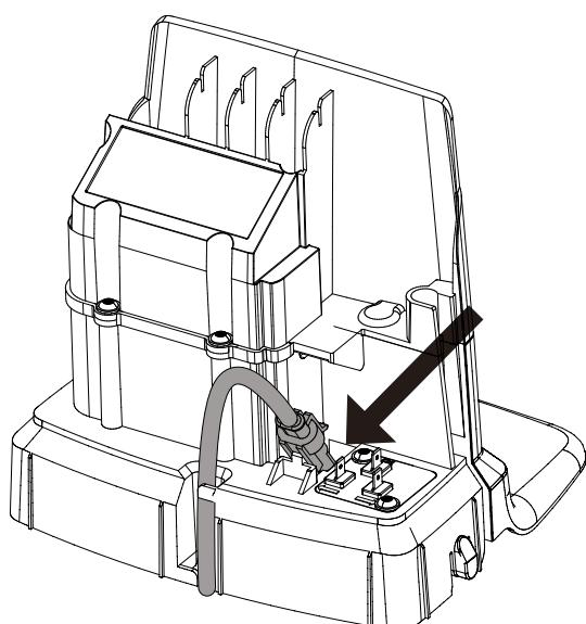
Podłączyć kabel niskonapięciowy do stacji ładowania.
