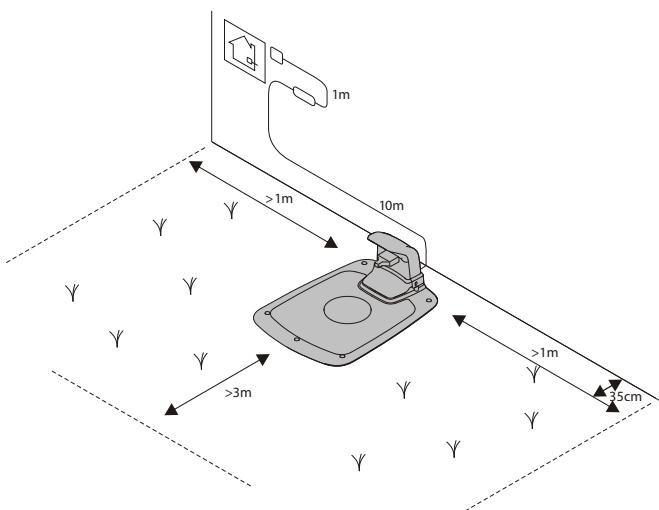
Robotul de tuns iarba utilizează firul de ghidare opțional pentru a-și regăsi drumul înapoi la stația de încărcare, dar și pentru a accesa spații greu de accesat din zona de lucru. De exemplu, firul de ghidare este instalat între stația de încărcare și o porțiune îndepărtată din zona de lucru sau printr-un spațiu îngust.
