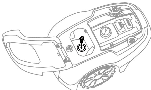
Sätt i säkerhetsnyckeln i gräsklipparen och vrid till positionen ON ( | ).
