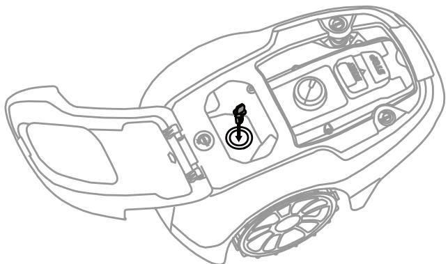
Вставьте в газонокосилку ключ безопасности и поверните в положение ВКЛ ( | ).
