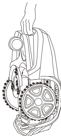
Pred dviganjem kosilnice pritisnite gumb **STOP** (USTAVI) in odstranite varnostni ključ.
