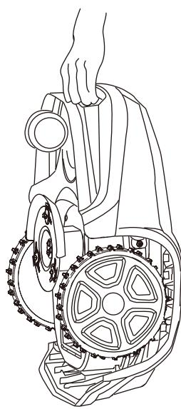
Trykk på **STOPP**-knappen på gressklipperen og ta ut sikkerhetsnøkkelen før du løfter gressklipperen.
