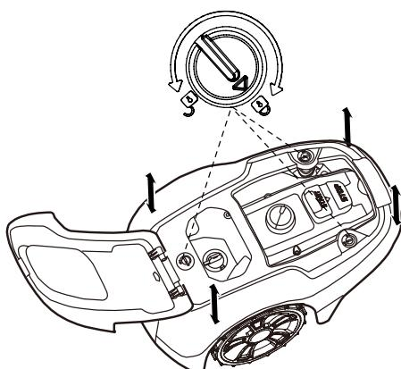
Obrócić pokrętło do pozycji odblokowującej i podnieść jej obudowę w jednym z rogów, po czym powtórzyć te same czynności we wszystkich 4 rogach, aż obudowa zostanie zdjęta z podwozia.
