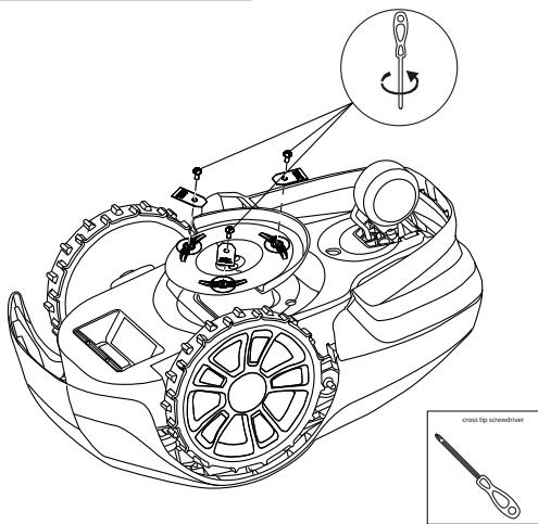
**VAROVANIE!** Stlačte tlačidlo STOP a pred výmenou čepelí vyberte bezpečnostný kľúč a nasaďte si ochranné rukavice.
