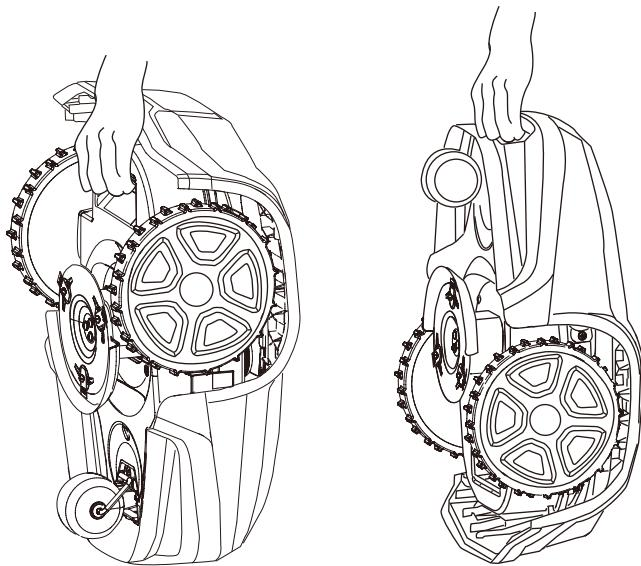
Appuyez sur le bouton **STOP** et retirez la clé de sécurité avant de soulever la tondeuse.
