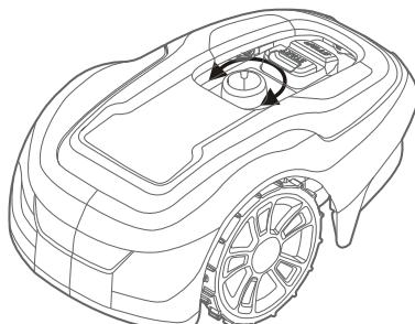
Sett klippehøyden til 60 mm de første ukene med gressklipping for å unngå å kutte grense- og ledekabelen. Senk innstillingen ett trinn hver uke etter dette til du har nådd ønsket klippehøyde.
