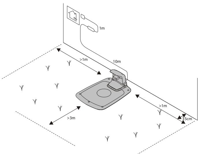
Stację ładowania należy ustawić w następujący sposób:
