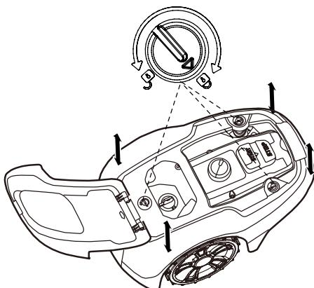
Otočte gombík do odomknutej polohy a pevne zdvihnite jeden z rohov krytu a zopakujte pre všetky štyri rohy, až kým sa kryt neuvolní z podvozku.
