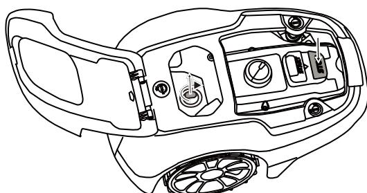
Нажмите кнопку **СТОП** на газонокосилке и выньте ключ безопасности.
