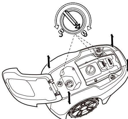
Rotiți butonul în poziție și deblocați și ridicați cu fermitate unul dintre colțurile caroserie și repetați procedura pentru toate colțurile, până când corpul este detasat de la șasiu.
