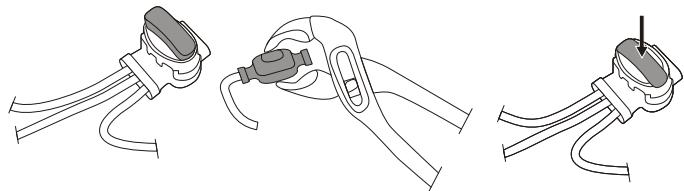
Wenn der Begrenzungsdraht zu kurz ist, verwenden Sie die mitgelieferten Spleiß- und Führungsdrähtverbinder, um den zusätzlichen Begrenzungsdraht wie folgt zu verbinden:
