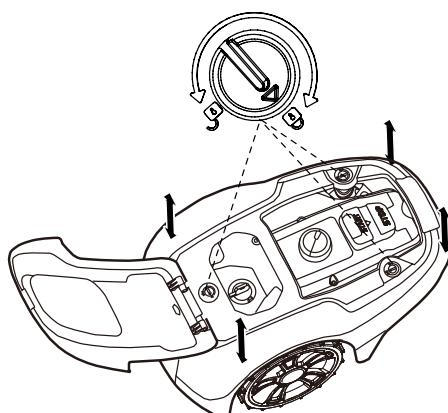
Fordítsa el a gombot a kioldás állásba, az egyik sarkánál fogva határozottan emelje fel a géptestet, ezt végezze el minden a négy sarokkal, amíg a géptest lazán le nem ugrik az alvázról.
