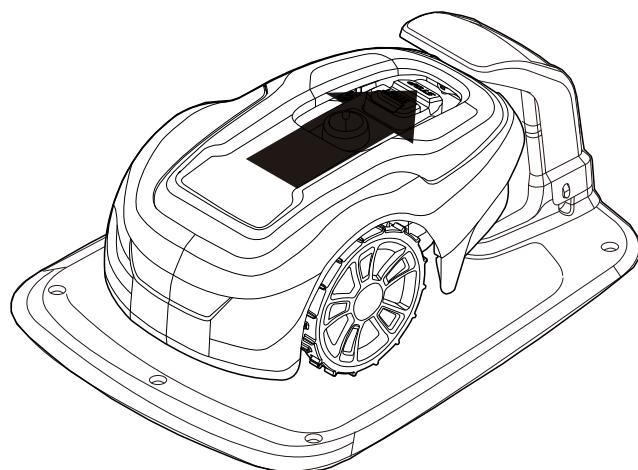
Coloque o corta-relva na estação de carregamento enquanto os fios-guia e fio de delimitação são colocados.
