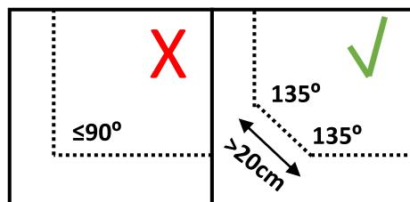
Косачката използва опционален направляващ проводник, за да открива своя път обратно към зарядното устройство, но и за откриване на трудно достъпни участъци на работната зона. Например, направляващият проводник се полага между зарядното устройство и отдалечена част на работната зона или през тесен проход.
