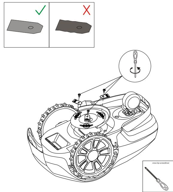
**¡ADVERTENCIA!** Pulse el botón de PARADA y retire la llave de seguridad antes de sustituir las cuchillas y lleve guantes de protección.
