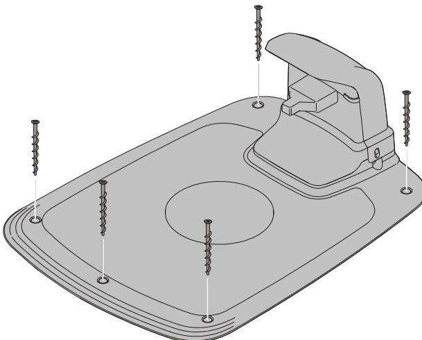
Fixez la station de charge au sol avec les cinq vis de fixation fournies à l'aide d'une clé hexagonale de 6 mm.
