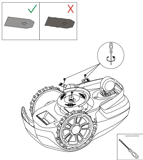
**AVERTISSEMENT !** Appuyez sur le bouton STOP et retirez la clé de sécurité avant le remplacement des lames, sans oublier de porter des gants de protection.
