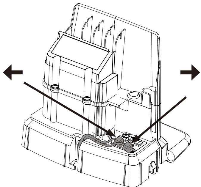
Conectați firul delimitator la stația de încărcare după cum urmează:
