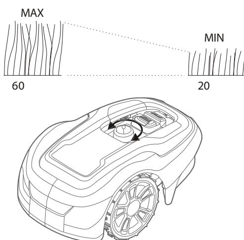
Aby nie dopuścić do przecięcia przewodu granicznego i przewodu prowadzącego, przez pierwszych kilka tygodni koszenia wysokość koszenia należy nastawić na 60 mm. Następnie ustawienie należy obniżać o jedną pozycję tygodniowo, aż do uzyskania żądanej wysokości koszenia.
