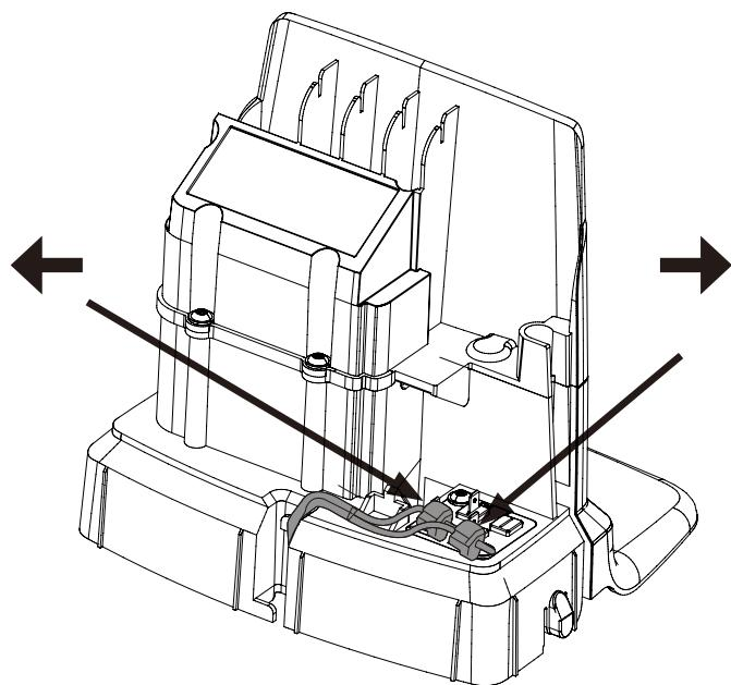
Připojte ohraničující drát k nabíjecí stanici, a to následujícím způsobem:
