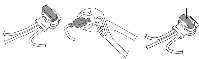
Если пограничный провод слишком короткий, используйте соединители для его удлинения следующим образом:
