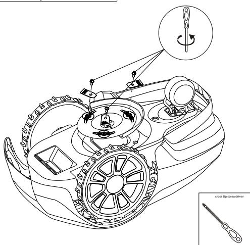
**VARNING!** Tryck på STOPP-knappen och ta ur säkerhetsnyckeln innan du byter ut knivarna. Använd skyddshandskar.
