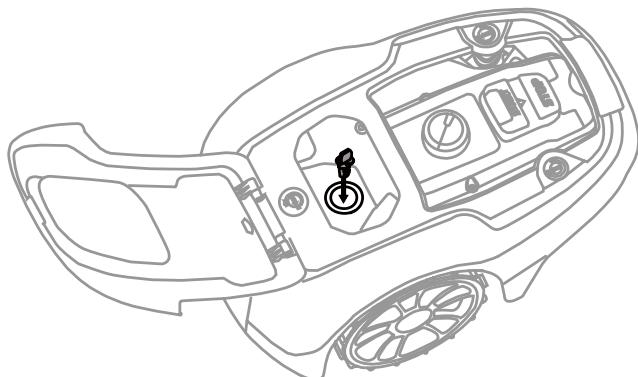
Vložte bezpečnostní klíč do sekačky a otočte jej do polohy ON (|).
