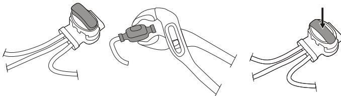
Illessze a határolóhuzal minden két végét és a vezetőhuzal végét a huzaltoldó vezetőhuzal összekötőbe. Ellenőrizze, hogy a huzalok teljesen a huzaltoldó vezetőhuzal összekötőben vannak-e úgy, hogy a végek láthatóak a huzaltoldó összekötőn keresztül.
