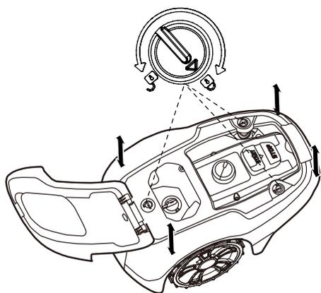
Drehen Sie den Knopf in die Entriegelungsposition und heben Sie die Karosserie an einer der Karosserieecken fest an und wiederholen Sie ihn für alle vier Ecken, bis sich die Karosserie vom Fahrgestell löst.
