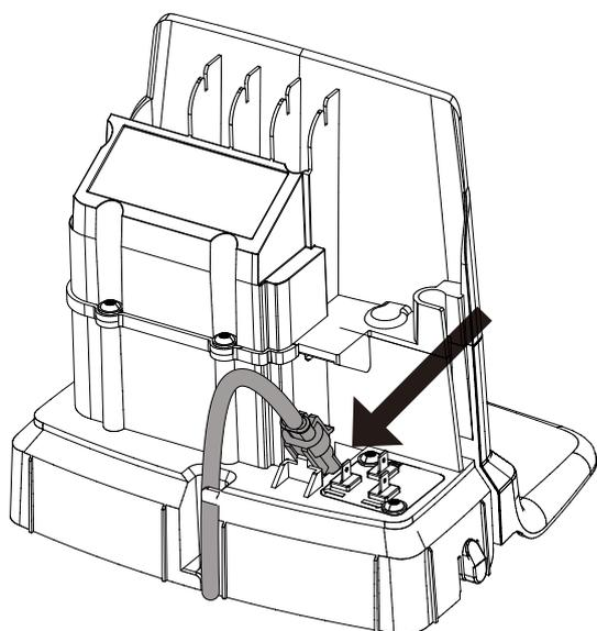
Priključite niskonapetostni kabel na polnilno postajo.
