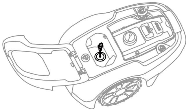
Ouvrez le capot de la tondeuse, insérez la clé de sécurité et tournez la jusque la position « Marche » ( | ).
