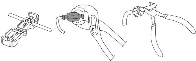
Kun rajalanka on täysin kaivettu maahan ja kiinnitetty, asenna loppulangan liittimet seuraavasti:
