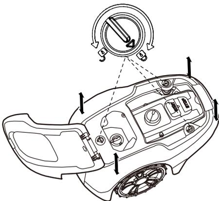
Zavrite gumb v odklenjeni položaj in trdno primite ter dvignite za enega od vogalov glavnega dela ter ponovite na vseh štirih vogalih, tako da se glavni del sname z okvirja.
