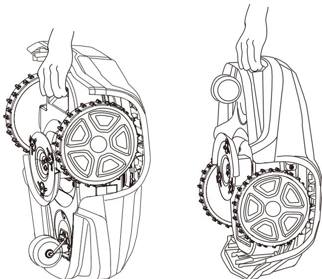
Appuyez sur le bouton **STOP** et retirez la clé de sécurité avant de soulever la tondeuse.
