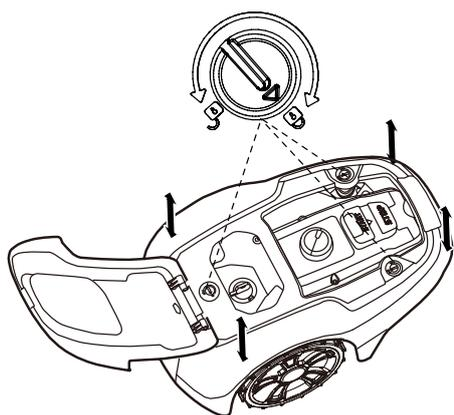
Otočte knoflíkem do odemčené polohy a zvedněte pevně jeden z rohů tělesa; zopakujte tento úkon u všech čtyř rohů, dokud se těleso neuvolní z podvozku.
