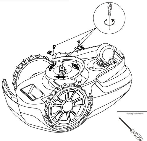
**VAROVÁNÍ!** Před výměnou nožů stiskněte tlačítko STOP a vyjměte bezpečnostní klíč; použijte ochranné rukavice.
