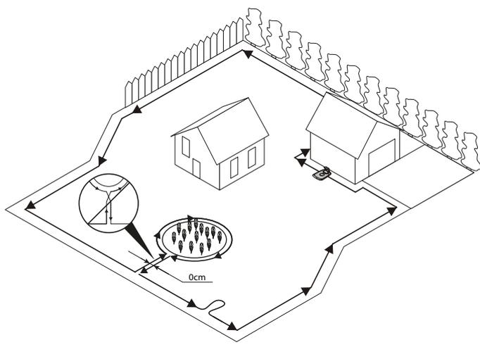
Fije temporalmente el extremo de la bobina de cable a una estaquilla u otro objeto en la estación de carga.
