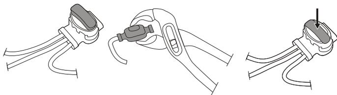
Illessze a határolóhuzal mindkét végét és a vezetőhuzal végét a huzaltoldó vezetőhuzal összekötőbe. Ellenőrizze, hogy a huzalok teljesen a huzaltoldó vezetőhuzal összekötőben vannak-e úgy, hogy a végek láthatóak a huzaltoldó összekötőn keresztül.
