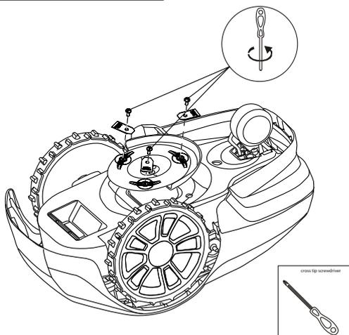
**WARNUNG!** Drücken Sie die STOP-Taste und ziehen Sie den Sicherheitsschlüssel ab, bevor Sie die Messer austauschen. Tragen Sie dabei Schutzhandschuhe.
