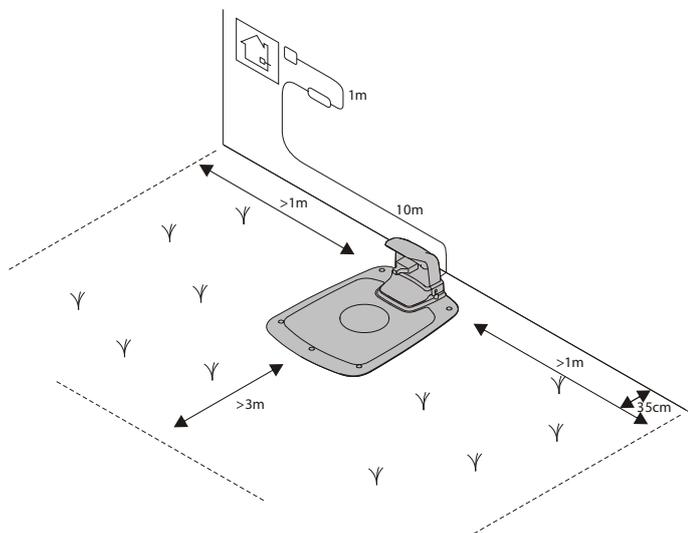
Poziționarea stației de încărcare după cum urmează:
