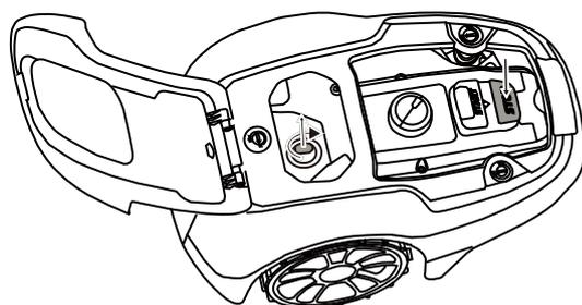
Na kosilnici pritisnite gumb **STOP** (USTAVI) in odstranite varnostni ključ.
