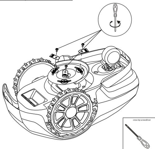
**WARNING! Tryck på STOPP-knappen och ta ur säkerhetsnyckeln innan du byter ut knivarna. Använd skyddshandskar.**
