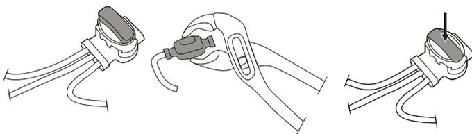
Se il cavo perimetrale è troppo corto, usare i connettori per giunti e cavi guida per giuntare l'altro cavo perimetrale, come indicato di seguito:
