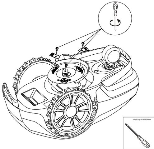
**AVVERTENZA!** Premere il tasto di ARRESTO e rimuovere la chiave di sicurezza prima di sostituire le lame; indossare guanti protettivi.
