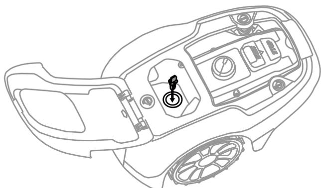
Inserte la llave en el cortacésped y gírela a la posición de encendido (I).
