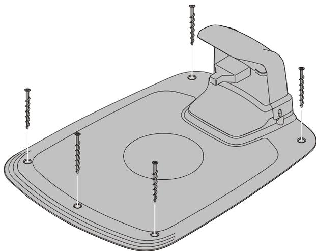
Fastgør ladestationen til underlaget med de fem medfølgende skruer ved hjælp af en 6 mm unbrakonøgle.
