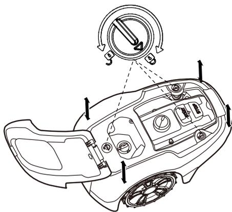
Ruotare la manopola in posizione di sbloccaggio, sollevare saldamente uno degli angoli del corpo e ripetere l'operazione su tutti e quattro gli angoli finché il corpo non si separa dal telaio.
