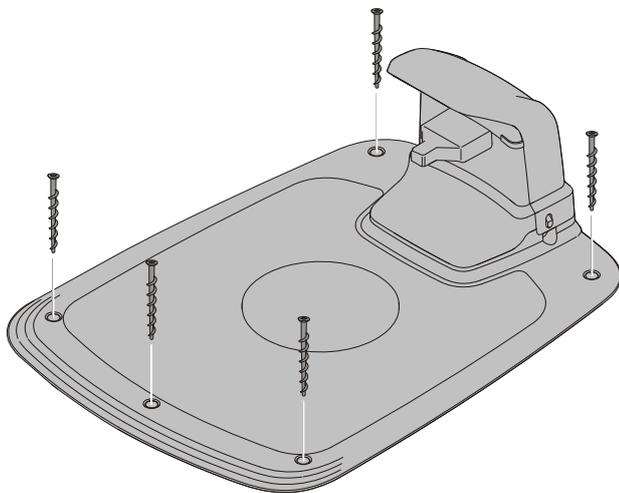
Befestigen Sie die Ladestation mit den fünf mitgelieferten Befestigungsschrauben mit einem 6 mm Innensechskant-Schlüssel am Boden.
