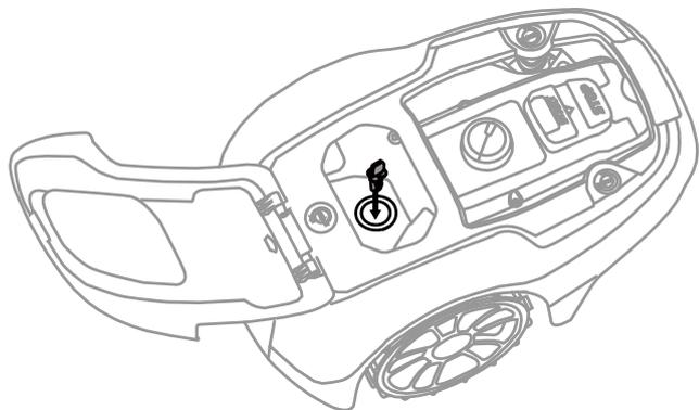
Sätt i säkerhetsnyckeln i gräsklipparen och vrid till positionen ON (|).
