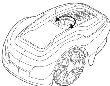
Stellen Sie in den ersten Wochen des Mähens die Schnitthöhe auf 60 mm ein, um das versehentliche Durchtrennen von Begrenzungsdraht und Führungsdraht zu vermeiden. Nachfolgend stufenweise jede Woche einen Schritt tiefer einstellen, bis die gewünschte Schnitthöhe erreicht ist.
