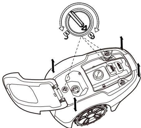
Rotiți butonul în poziția deblocat și ridicați cu fermitate unul dintre colurile caroseriei și repetați procedura pentru toate colurile, până când corpul este detașat de șasiu.
