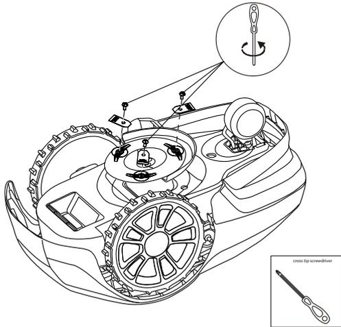
**¡ADVERTENCIA!** Pulse el botón de PARADA y retire la llave de seguridad antes de sustituir las cuchillas y lleve guantes de protección.
