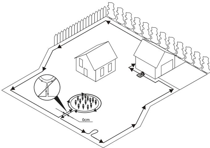
Befestigen Sie das Ende des Schleifendrahts vorübergehend an einem Haken oder einem anderen Gegenstand an der Ladestation.
