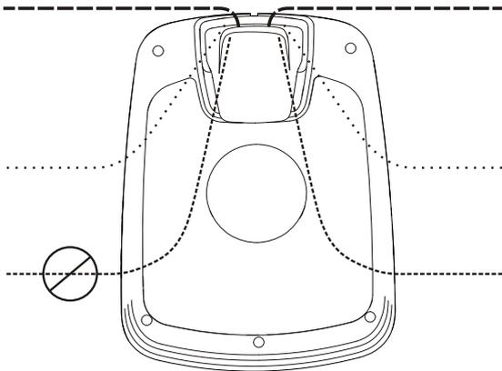
Toda la estación de carga debe estar dentro de la superficie de trabajo como se muestra en la figura.
