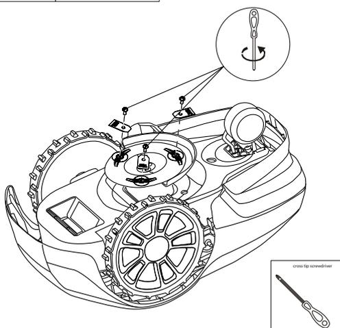
**VAROVANIE!** Stlačte tlačidlo STOP a pred výmenou čepeľí vyberte bezpečnostný kľúč a nasadte si ochranné rukavice.
