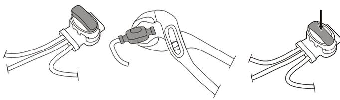
Si el cable delimitador es demasiado corto, utilice los conectores suministrados de empalme y de cable de guía para empalmar el cable delimitador adicional del siguiente modo:
