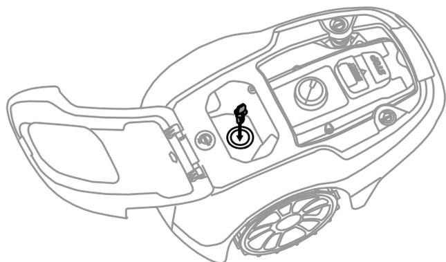
Vstavite varnostni ključ v kosilnico in ga obrnite v položaj za vklop ( | ).
