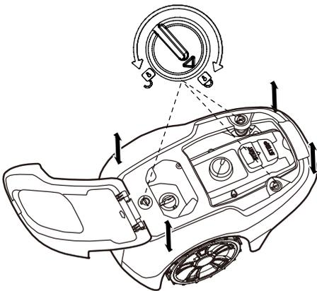
Drej håndtaget, så det er åbent, og løft med et fast tag et hjørne af kabinettet, og gentag for alle fire hjørner, indtil kabinettet løsner sig fra chassiset.
