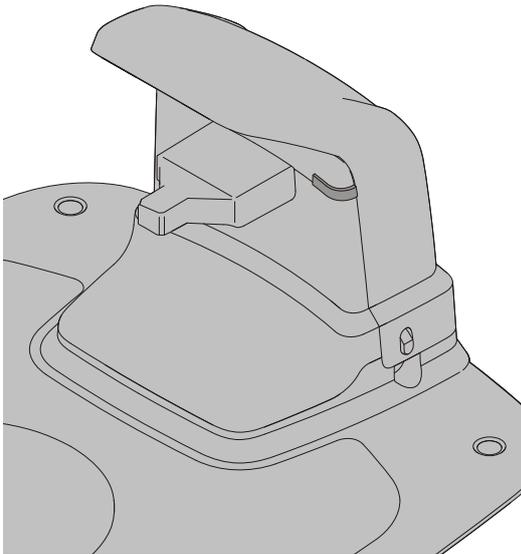
Kiinnitä latausasema maahan käyttäen viittä mukana toimitettua kiinnitysruuvia ja 6 mm:n kuusiokoloavainta.
