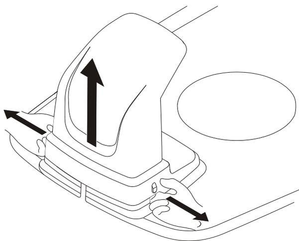
Retirez le cache de protection de la station de charge en appuyant sur les languettes de chaque côté de la base tout en levant le cache.
