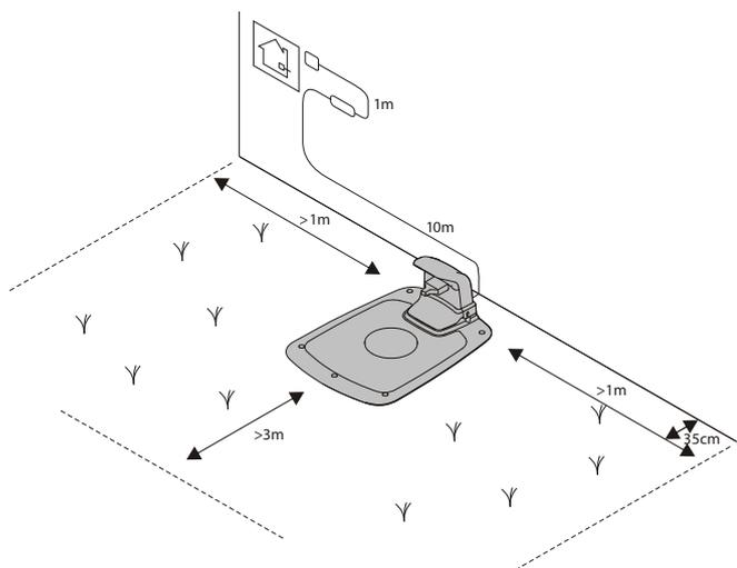
O corta-relva usa o fio-guia opcional para encontrar o seu caminho de volta para a estação de carregamento, mas também encontra áreas de difícil alcance da área operacional. Por exemplo, o fio-guia é colocado entre o carregador e uma parte remota da área de trabalho ou através de uma passagem estreita.
