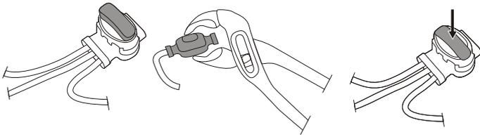
Sätt i begränsningskabelns båda ändar samt guidekabelns ena ände i skarven och guidekabelkopplingen. Kontrollera att kablarna är helt isatta i skarven och guidekabelkopplingen så att ändarna är synliga genom skarven och guidekabelkopplingen.
