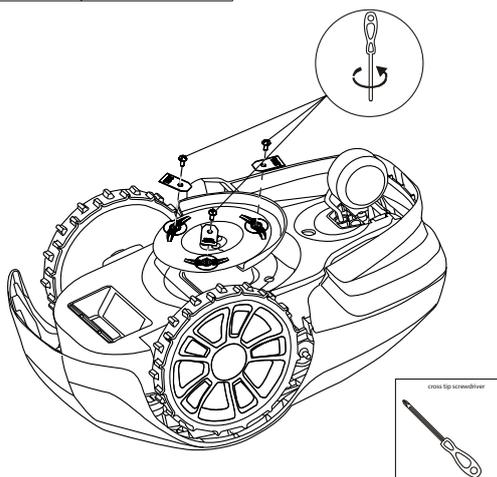
**AVISO!** Pressione o botão STOP e remova a chave de segurança antes de substituir as lâminas e use luvas de proteção.
