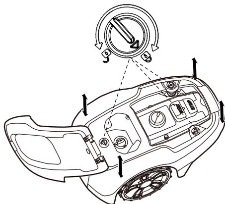
Rode o manípulo para a posição de desbloqueado e levante firmemente um dos cantos da estrutura e repita para todos os quatro cantos, até que a estrutura se solte do chassis.
