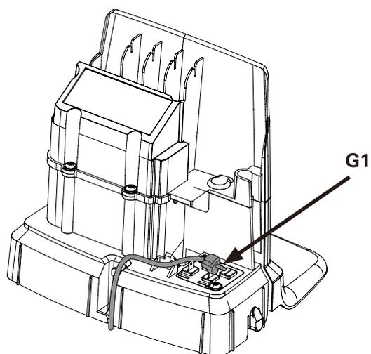
Schließen Sie den Führungsdraht wie folgt an die Ladestation an:
