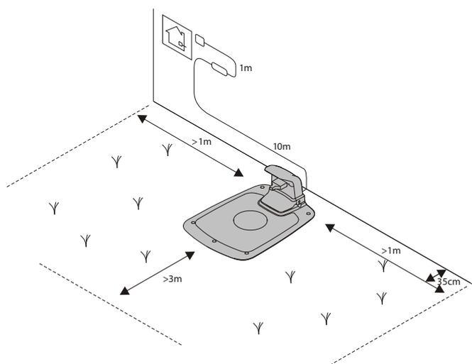
Kosilica se služi žicom vodilicom koja je dodatna oprema kako bi našla put prema stanici za punjenje, ali za nalaženje teško dostupnih dijelova radnog područja. Primjerice, žica vodilica se položi između stanice za punjenje i udaljenog dijela radnog prostora ili kroz uski prolaz.
