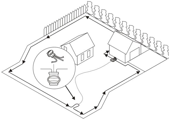
Mit dem optionalen Führungsdraht findet der Mäher den Weg zurück zur Ladestation, aber auch schwer zugängliche Bereiche des Betriebsbereichs. So wird beispielsweise der Führungsdraht zwischen der Ladestation und einem abgelegenen Teil des Arbeitsbereichs oder durch einen engen Durchgang verlegt.
