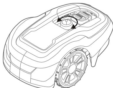
Aby nie dopuścić do przecięcia przewodu granicznego i przewodu prowadzącego, przez pierwszych kilka tygodni koszenia wysokość koszenia należy nastawić na 60 mm. Następnie ustawienie należy obniżyć o jedną pozycję tygodniowo, aż do uzyskania żądanej wysokości koszenia.
