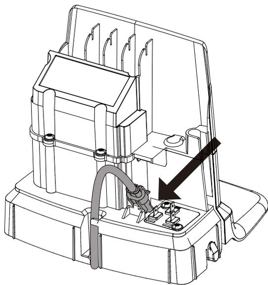
Connectez le câble basse tension à la station de charge comme indiqué sur le schéma.
