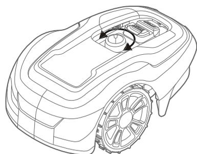
Para as primeiras semanas de corte, defina a altura de corte para 60 mm para evitar cortar o fio de delimitação e fio-guia. Reduza a configuração um passo a cada semana daí em diante até atingir a altura de corte desejada.
