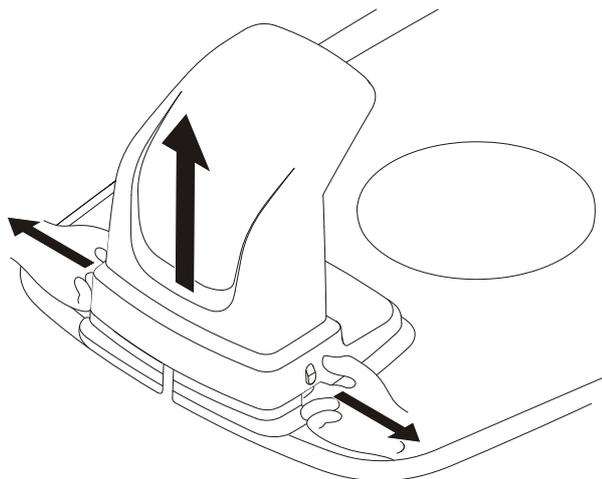
Remova a tampa protetora na estação de carregamento ao premir as guias de cada lado da base e levantar a tampa.
