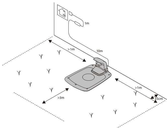
La tondeuse utilise le fil de guidage optionnel pour retrouver son chemin à la station de charge mais aussi pour identifier les endroits difficiles à atteindre dans la zone de travail. Par exemple, le fil de guidage est posé entre la station de charge et une partie distante de la zone de travail ou dans un passage étroit.
