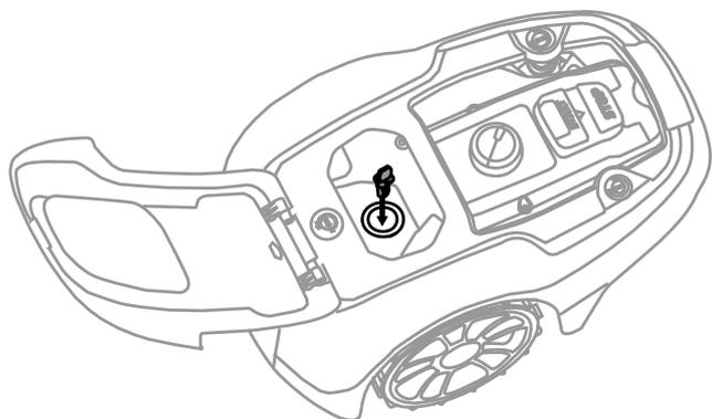
Insira a chave de segurança na máquina de cortar relva e coloque-a na posição de ligado ( | ).
