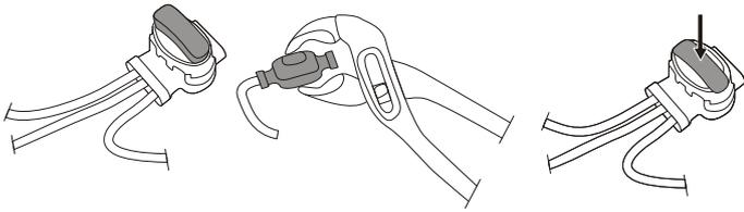
Sett begge endene av grensekabelen og enden av ledekabelen inn i skjøte- og ledekabelkoblingen. Sjekk at kablene er satt helt inn i koblingen så du ser endene gjennom den.
