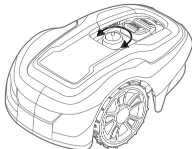
În primele săptămâni de tuns, setați înălțimea de tăiere la 60mm pentru a evita tăierea firului de delimitare și a firului de ghidare. Coborâți înălțimea cu un nivel în fiecare săptămână după aceasta până când înălțimea de tăiere dorită este obținută.
