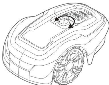
Sett klippehøyden til 60 mm de første ukene med gressklipping for å unngå å kutte grense- og ledkabelen. Senk innstillingen ett trinn hver uke etter dette til du har nådd ønsket klippehøyde.
