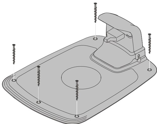
Proteja a estação de carregamento no chão usando os cinco parafusos de fixação fornecidos e uma chave Allen de 6 mm.
