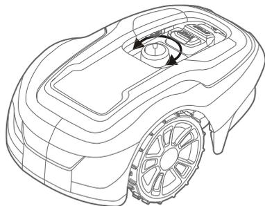
Durante las primeras semanas de corte, ajuste la altura de corte a 60 mm para evitar cortar el cable delimitador y el cable de guía. Posteriormente, baje el ajuste un paso cada semana hasta que se alcance la altura de corte deseada.
