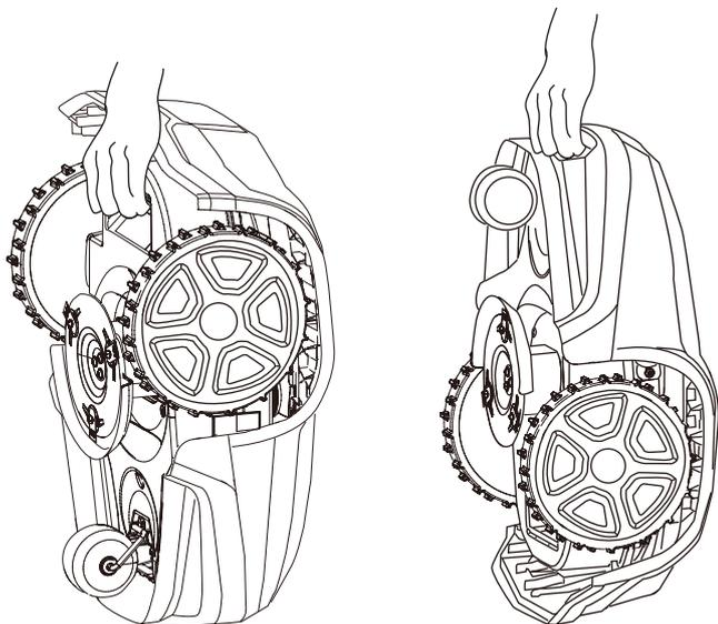
Trykk på **STOPP**-knappen på gressklipperen og ta ut sikkerhetsnøkkelen før du løfter gressklipperen.
