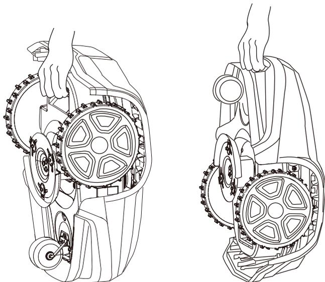
Перед тем как поднять газонокосилку, нажмите кнопку **СТОП** и выньте ключ безопасности.
