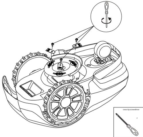
**OPOZORILO!** Preden zamenjate rezila, pritisnite gumb **STOP (USTAVI)** in odstranite varnostni ključ, pri tem pa nosite zaščitne rokavice.
