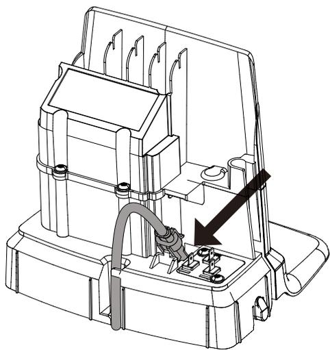
Schließen Sie das Niederspannungskabel an die Ladestation an.
