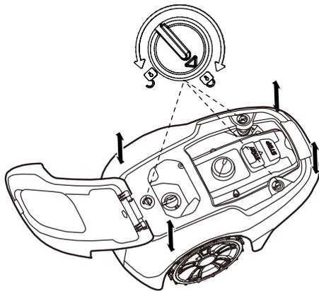
Drei knotten til opplåsningsposisjon og løft den fast i et av hjørnene på kroppen og gjenta for alle fire hjørnene, til karosseriet spretter løs fra kabinettet.
