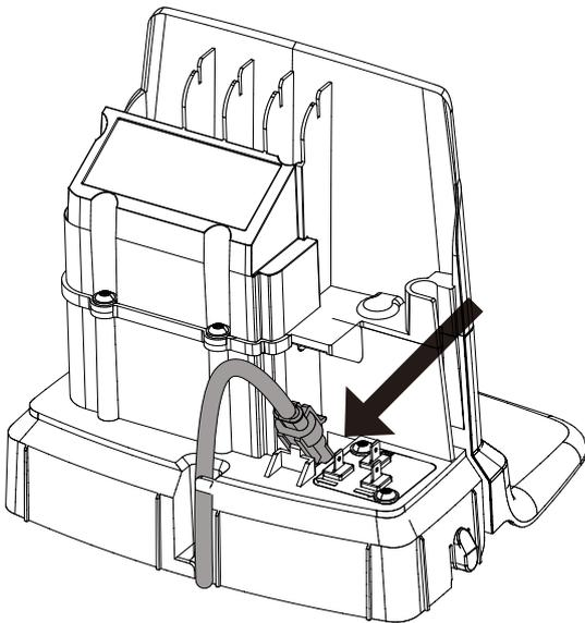
Csatlakoztassa a kisfeszültségű kábelt a töltőállomáshoz.
