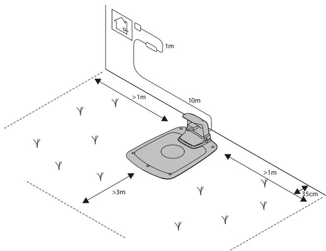
Kosiarka wykorzystuje opcjonalny przewód prowadzący, za pomocą którego odnajduje drogę powrotną do stacji ładowania, przewód prowadzący pomaga też znaleźć trudno dostępne fragmenty terenu w strefie pracy. Na przykład, przewód prowadzący może zostać położony między stacją ładowania a odległą częścią strefy pracy lub w wąskim przesmyku.
