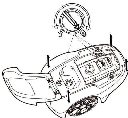
Okrenite gumb u položaj za otključavanje i vrsto podignite na jednom od kutova kućišta i ponovite za sva četiri kuta, tako da se kućište odvoji od šasije.
