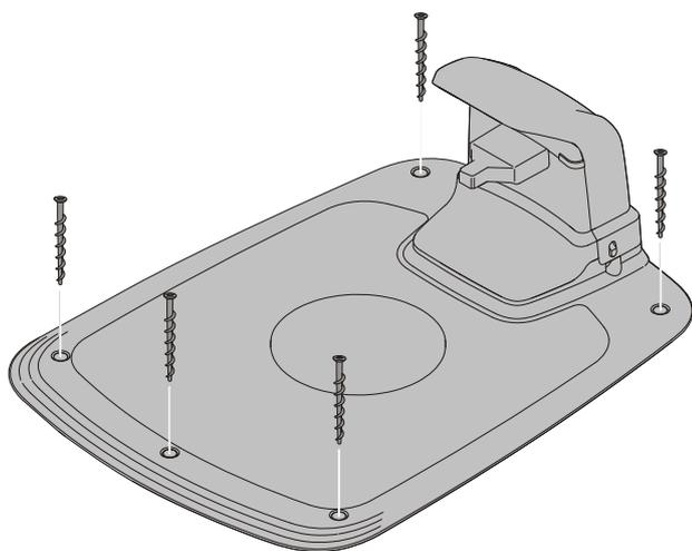
Fissare la stazione di ricarica al terreno con cinque viti utilizzando una chiave esagonale da 6 mm.
