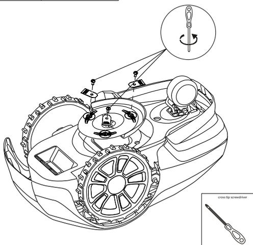
**AVERTISMENT!** Apăsați butonul STOP și îndepărtați cheia de siguranță înainte de a înlocui lamele și purtați mănuși de protecție.
