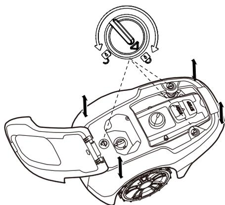
Draai de knop om de positie te ontgrendelen en trek stevig aan een van de hoeken van de behuizing en herhaal dit bij alle vier de hoeken totdat de behuizing los komt van het chassis.
