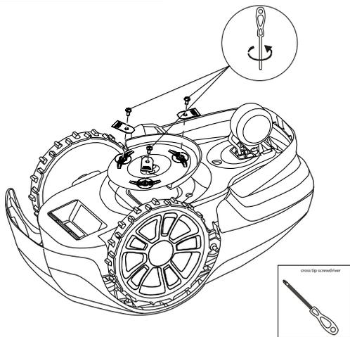
**AVERTISSEMENT ! Appuyez sur le bouton STOP et retirez la clé de sécurité avant le remplacement des lames, sans oublier de porter des gants de protection.**
