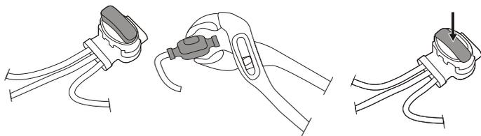
Inserire entrambe le estremità del cavo perimetrale e l'estremità del cavo guida nel connettore per giunti e cavi guida. Controllare che i cavi siano completamente inseriti nel connettore, in modo che le estremità siano visibili attraverso il connettore stesso.
