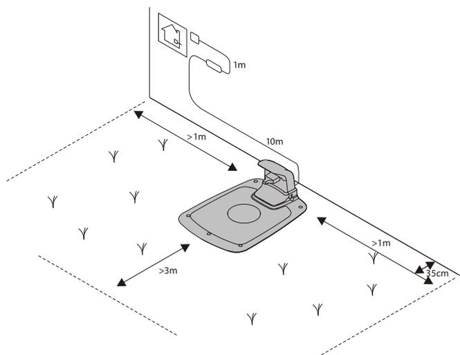
Il tosaerba utilizza il cavo guida facoltativo per individuare il percorso di ritorno verso la stazione di ricarica, ma anche per individuare le aree più difficili da raggiungere. Ad esempio, il cavo guida viene steso tra la stazione di ricarica e un punto lontano dell'area di lavoro oppure in un passaggio stretto.
