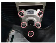
18) Disassemble fan motor angle ass'y.(2 screws)
