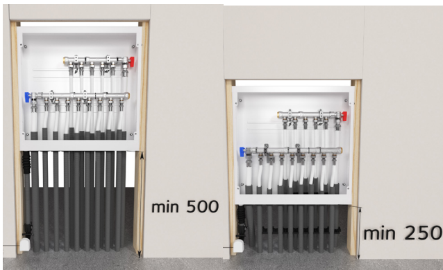
Exempel montagehöjd utan och med fixeringsplatta.
