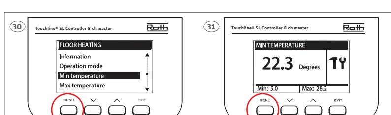
**(DK)** OBS! Når gulvføleren anvendes til "Beskyttelse af gulvet" vil opvarmningen stoppe hvis temperaturen overstiger den indstillede max. temperatur. Når gulvføleren anvendes til "Komfort" har rumtermostaten prioritet så længe temperaturen ligger imellem indstillet min. og max. temperaturer.
