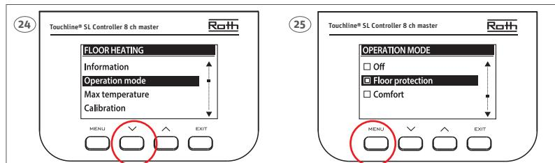
**(DK)** Indstil max. temperatur for at beskytte dit gulv.
