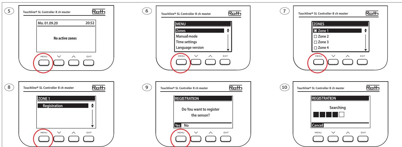
**(DK)** Tilmeld en rumtermostat til en kanal på kontrollenheden. Følg trin 5 til 10 og tryk på tilmeldingsknappen vist som trin 11. Afslut med tryk på Menu og derefter tryk flere gange på Exit indtil standardvisning. Alle el-forbindelser til pumpe, termomotorer og evt. relæ skal udføres inden der sættes 230V til kontrollenheden, se monteringsvejledningen for dette.
