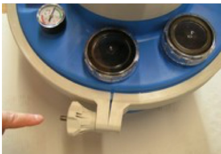
Foto 4.1a - bemærk at der her medfølger en spændeknop i plast til at spænde spændebåndet.
