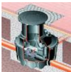
Med en pumpebrønd samles vandet ét sted og pumpes ud.
