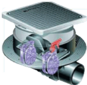
Højvandslukkets to klapper gør, at vandet ikke kan komme ind via gulvafløbet.
