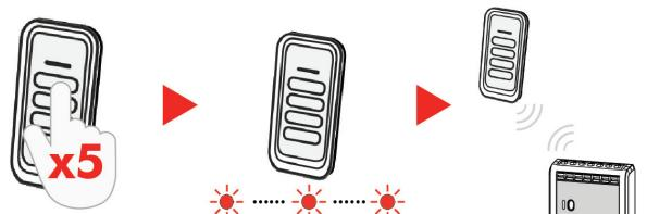
NOTA: La conexión del transmisor al receptor puede tardar entre 5 y 15 segundos
