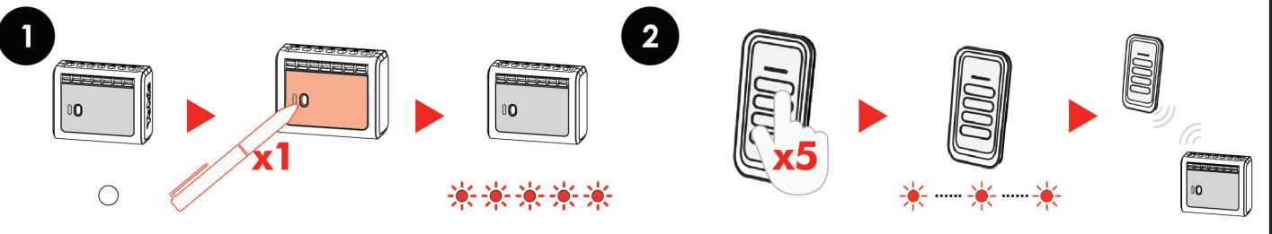
NB : La connexion de l'émetteur au récepteur peut prendre entre 5 et 15 secondes
