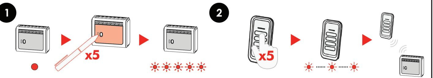
Hinweis: Der Verbindungsauflauf zwischen Sender und Empfänger kann zwischen 5 und 15 Sekunden dauern
