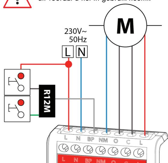
Door het R12M accessoire met dubbele drukknop te gebruiken, zendt de groene draad van de R12M alleen het sluitcommando terwijl de bruine draad alleen het openingscommando zendt.
