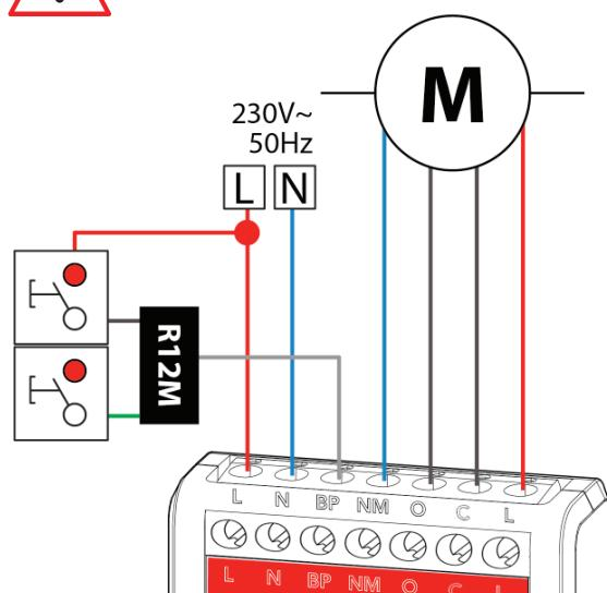
Wenn das Zubehör R12M mit Doppeltaster verwendet wird, wird das grüne Kabel des R12M nur den Schließbefehl senden, während das braune Kabel nur den Öffnungsbefehl sendet.
