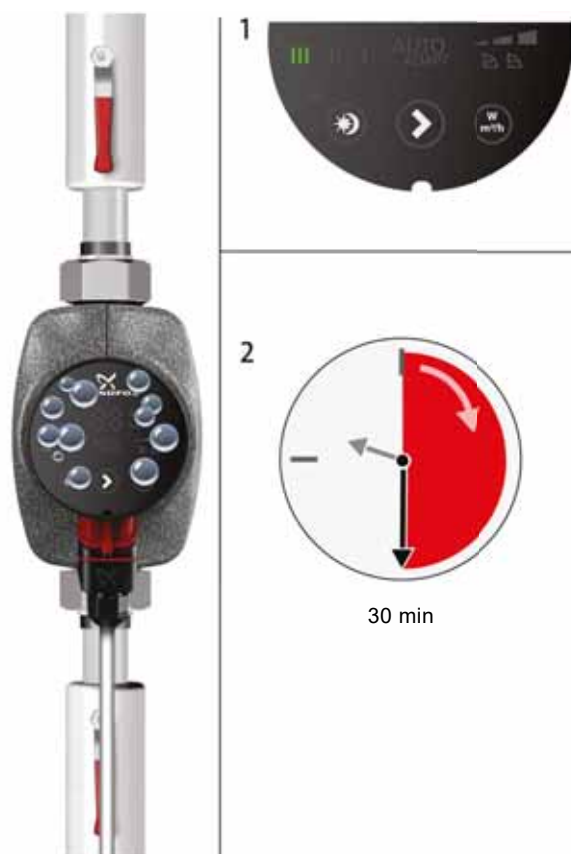
Fig. 8 Utlufting av pumpen
