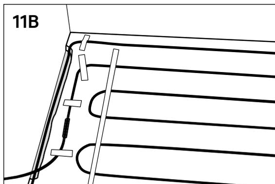
(Bild 12) När det redan ligger värmekabel i ytterspår, skär ända ner till betonggolvet och lägg kabeln i det utskurna utrymmet.
