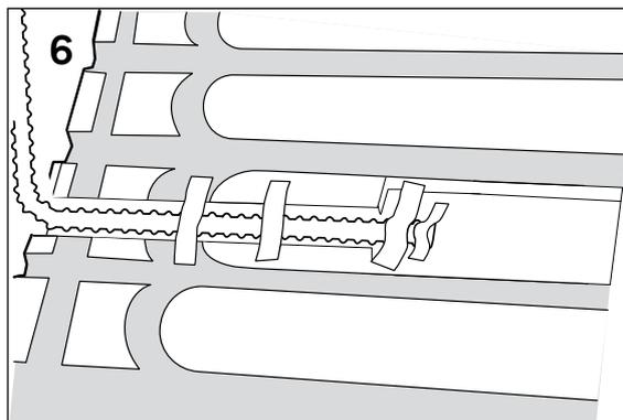
(Billede 7) Skær et lille spor yderst i pladen, således at tilslutningskablet kan passere frem til pladens yderste spor.
