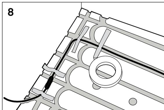
(Billede 9) Vend i det næstyderste, brede spor på pladens korte side. Sæt tape på lige inden for det brede spor, og lad taperullen blive siddende. Fortsæt på samme måde, indtil der ikke er mere kabel, og alle spor undtagen ydersporene er fyldt.
