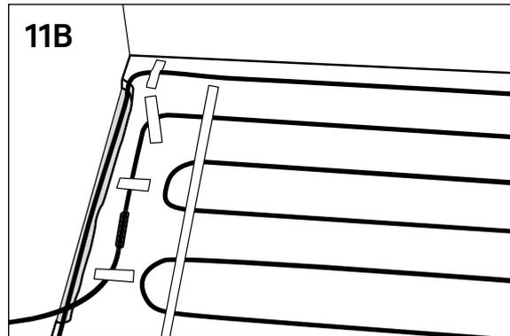
(Bilde 12) Hvis det allerede ligger varmekabel i yttersporene, skjærer du helt ned til betonggulvet og legger kabelen i den utskårne plassen.
