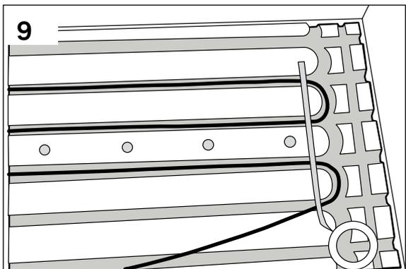
(Bilde 10) Hvis du har kabel til overs når alle spor er fylt. Legg den i tomme ytterspor, i første omgang mot yttervegger.
