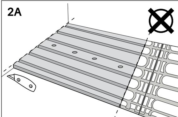
Vådrum Cable Board lægges ikke i brusezonen, hvor fald skal spartles mod gulvafløbet. Vi anbefaler i stedet Ebeco Thermo Board (89 601 60) til denne overflade. Monter Thermo Board i overensstemmelse med den medfølgende anvisning. Kablet lægges i overensstemmelse med instruktionen direkte mod Thermo Board-pladen.
