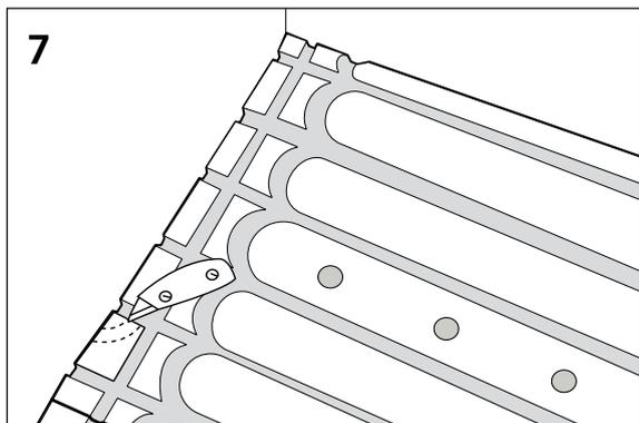
(Billede 8) Læg tilslutningskablet i sporet, og fortsæt til nærmeste hjørne. Fastgør det med tape indtil det brede spor på pladens korte side, og lad taperullen blive siddende. Læg kablet i det næstyderste spor, og fortsæt mod den modsatte væg.
