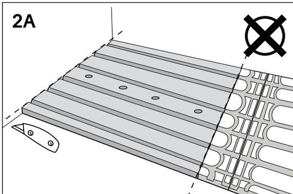
**Våtrum** Cable Board förläggs inte i duschzonen där fall ska spacklas mot golvbrunnen. Vi rekommenderar istället Ebeco Thermo Board (89 601 60) för denna yta. Montera Thermo Board enligt medföljande anvisning. Kabeln läggs enligt instruktion direkt mot Thermo Board-skivan.
