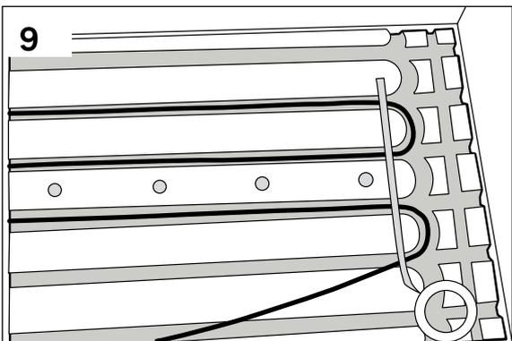
(Bild 10) Om du får kabel över när alla spår är fyllda. Lägga den i tomma ytterspår, i första hand mot ytterväggar.
