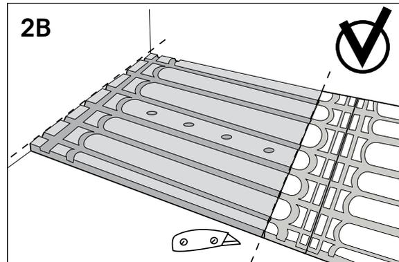
(Bilde 3) Skjær ut et spor til spiralslangen til føleren for gulvvarmestaten. Skjær deretter ut en firkant på 10x30 cm, men bare i 1 cm dybde. Her skal føleren plasseres senere.
