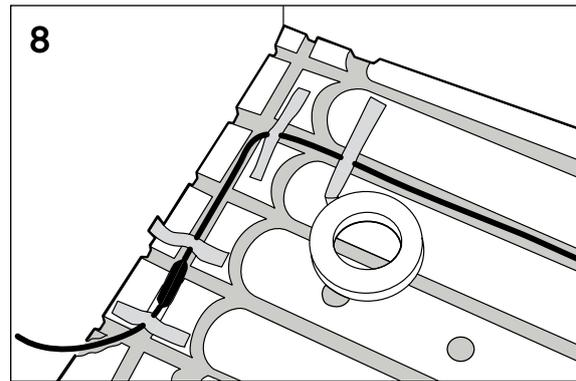
(Bild 9) Vänd i det näst yttersta, breda spåret på skivans kortsida. Tejpa direkt innanför det breda spåret och låt tejprollen sitta kvar. Fortsätt likadant tills kabeln tar slut och alla spår utom ytterspåret är fyllda.
