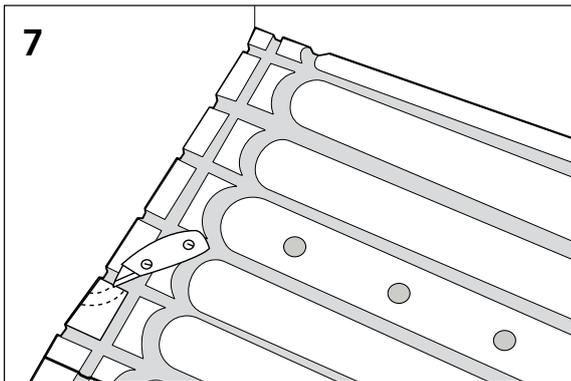
(Bild 8) Lägga anslutningskabeln i spåret och fortsätt till närmsta hörn. Fäst med tejp intill det breda spåret på skivans kortsida och låt tejprollen sitta kvar. Lägga kabeln i det näst yttersta spåret och fortsätt mot motsatt vägg.
