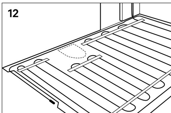
(Bild 13) Tejpa nya tejprensor parallellt med de första tejprensorna, ca 6 remsor/meter.
