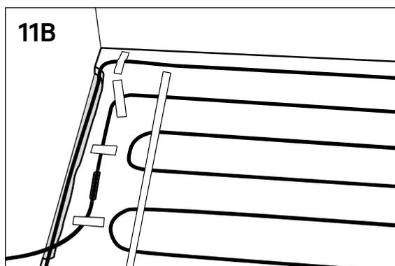
(Billede 12) Hvis der allerede ligger varmekabel i ydersporene, skal du skære helt ned til betongulvet og lægge kablet i den udskårne fordybning.
