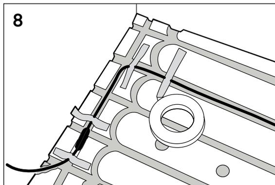
(Bilde 9) Snu i det nest ytterste, brede sporet på platens kortsida. Tape rett innenfor det brede sporet, og la taperullen sitte på. Fortsett på samme måte til det er slutt på kabelen og alle spor unntatt yttersporene er fylt.
