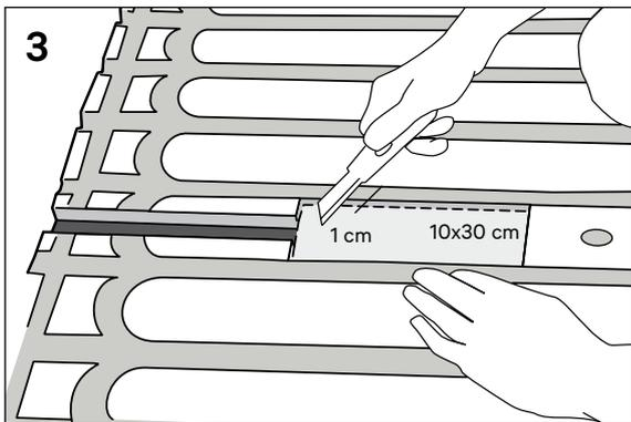
(Bilde 4) Fjern platene. Legg primer på gulvet og la det tørke. Legg på flytsparkel med en 8-10 mm rundtannet sparkel.
