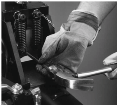
Fig 20: Løsn det øvre skaft.
