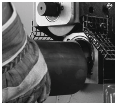
Fig 09: Læg røret over valsen.
