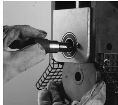
Fig 21: Træk det øvre skaft ud.
