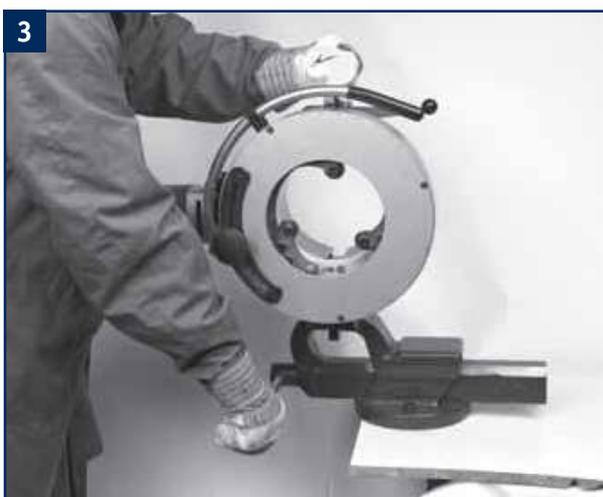
3 Rørskeereren er monteret med en fodplade til fastspænding i et skruestik.
