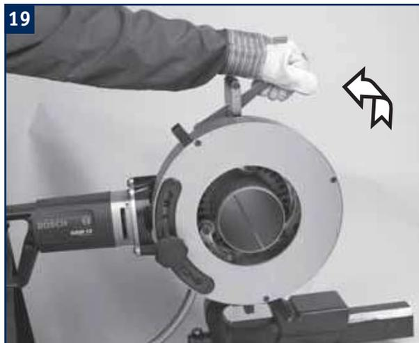
Træk håndtaget tilbage for at låse tilspændingsmodulet.
