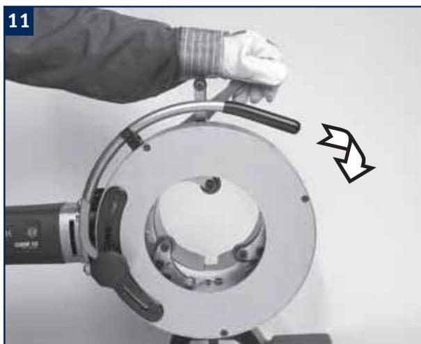
Skub tilspændingsmodulets håndtag frem, for at åbne indsatsbakken.
