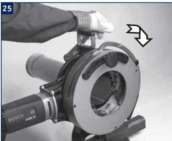
Træk håndtaget for tilspændingsmodulet tilbage for at løsne røret.
