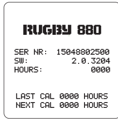
Kalibrering Alarm på Start-op skærm
