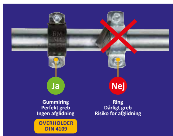
Fig. 46 - Gummiring PRATIKO iht. DIN 4109 (RM-serie 355/G – 351/G – 555/G – 156/G)
