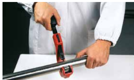
Fig. 25 - Tilskæring af rør
