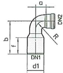
**90° bøjninger, reducerede, med kort muffle 4A i henhold til EN 1123 form E3, i henhold til DIN 19530 form G4**
