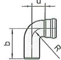
**90° bøjninger med kort muffle 4A i henhold til EN 1123 form ./, i henhold til DIN 19530 form G2**
