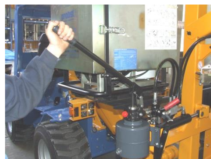
Når håndpumpen betjenes, bevæger masten sig mod venstre .
