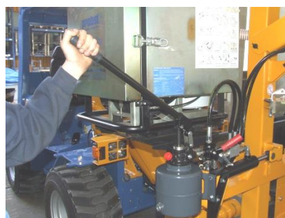
Når håndpumpen betjenes, sænkes masten.
