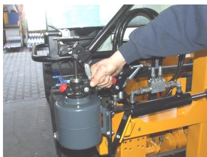
Det røde stillehåndtag anbringes i position A
