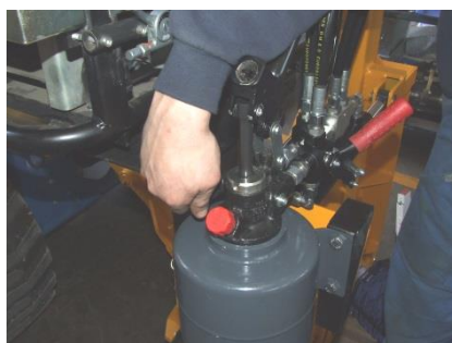
Anbring stillehåndtaget på håndpumpen i position II
