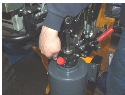
Anbring stillehåndtaget på håndpumpen i position II
