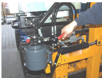
Det røde stillehåndtag anbringes i position B
