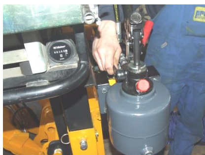
Anbring stillehåndtaget på håndpumpen i position I
