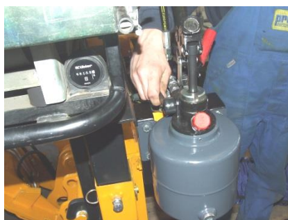
Anbring stillehåndtaget på håndpumpen i position I
