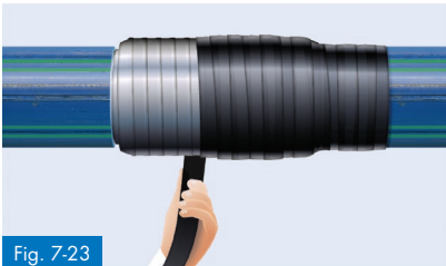
Fig. 7-23 Svejsesfittingen omvikles med Densolen tape AS 40
