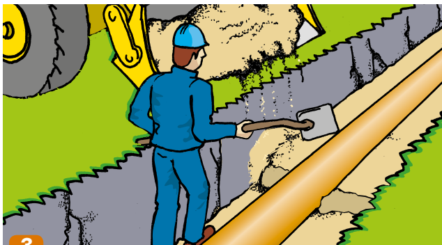
3 Det är viktigt att understoppning utförs på den undre fjärdedelen av röret så det får ett bra stödfundament.
