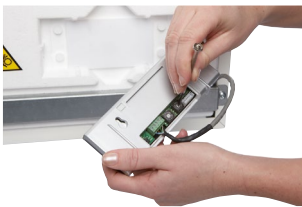
Indregulering af kontrolpanelet
