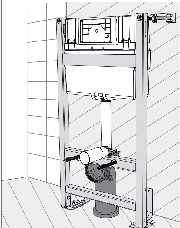
Skruvinfästningar i våtzon 1 ska göras i massiv konstruktion såsom betong, reglar, särskild konstruktionsdetalj eller i Våtrumsvägg 2012.
