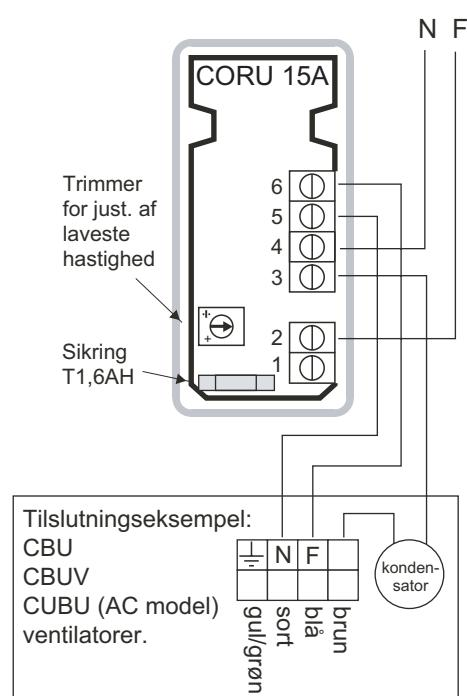
OBS: Der skal anvendes en 4 ledet for at forbide ventilatorer til denne regulator:
